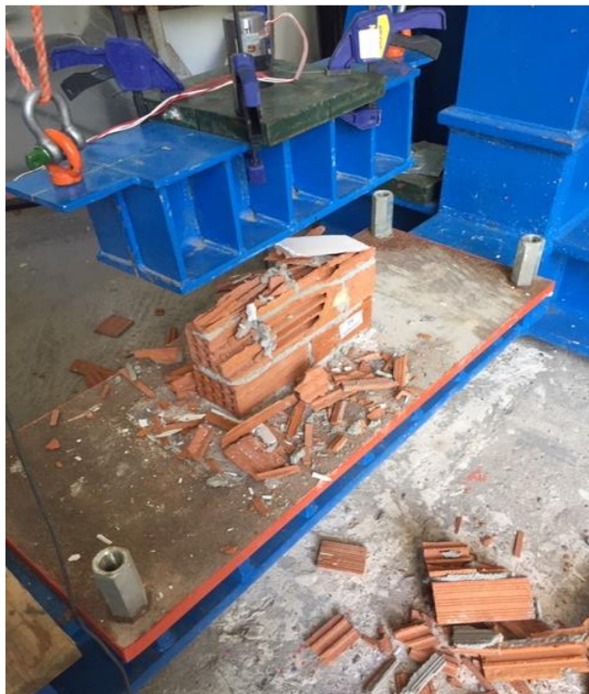
Εικόνα 5-19: Αστοχία τοίχου T9 κατά τον προσδιορισμό του μέγιστου θλιπτικού φορτίο
