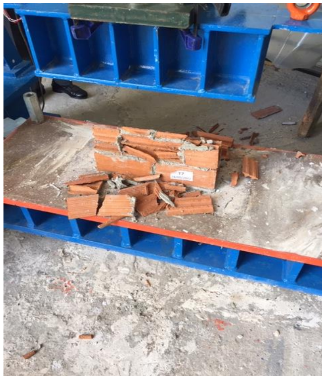
Εικόνα 5-15: Αστοχία τοίχου T7 κατά τον προσδιορισμό του μέγιστου θλιπτικού φορτίο
