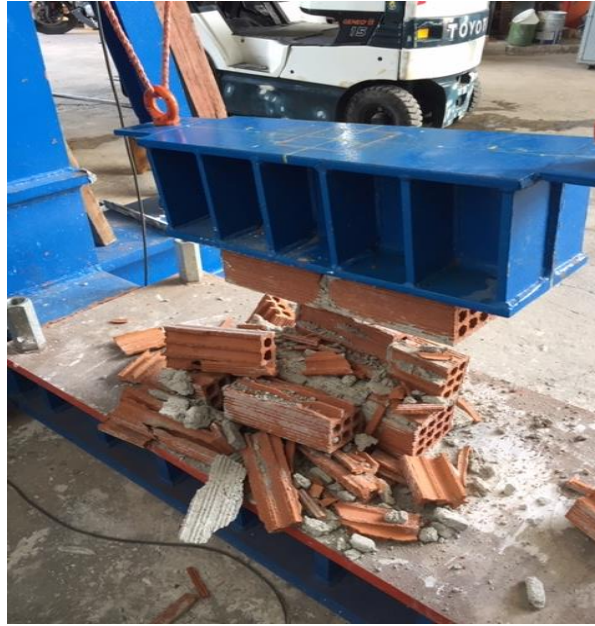
Εικόνα 5-4: Αστοχία τοίχου T17 κατά τον προσδιορισμό του μέγιστου θλιπτικού φορτίο
