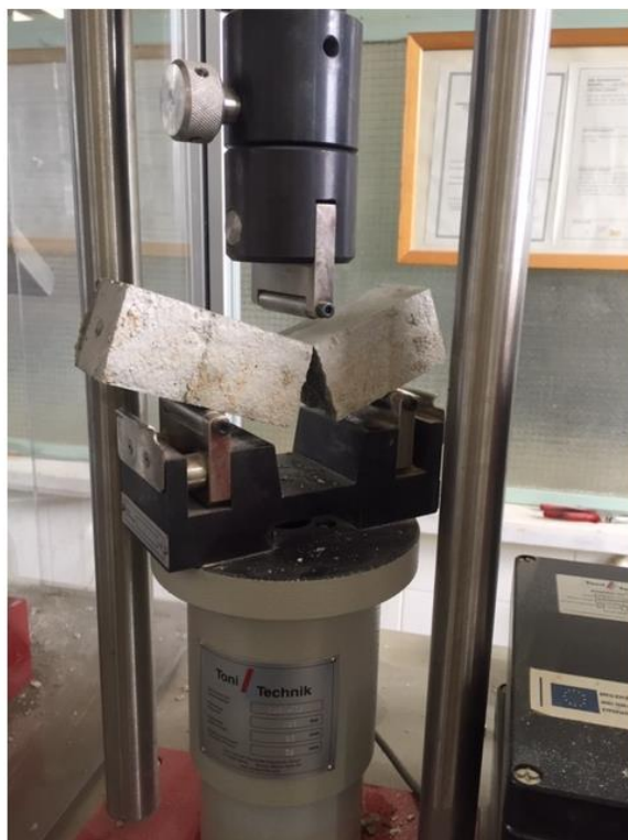
Εικόνα 2-6: Κάμψη τριών σημείων σε δοκίμια κονιάματος δόμησης
