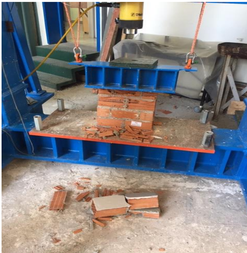
Εικόνα 5-16: Αστοχία τοίχου T5 κατά τον προσδιορισμό του μέγιστου θλιπτικού φορτίου
