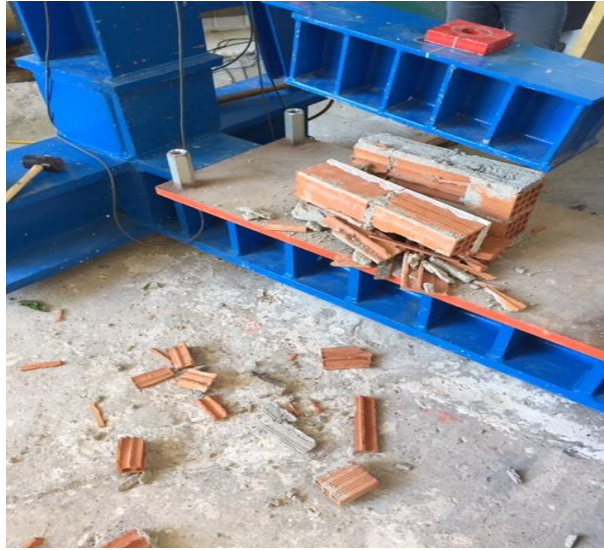
Εικόνα 5-10: Αστοχία τοίχου T22 κατά τον προσδιορισμό του μέγιστου θλιπτικού φορτίου
