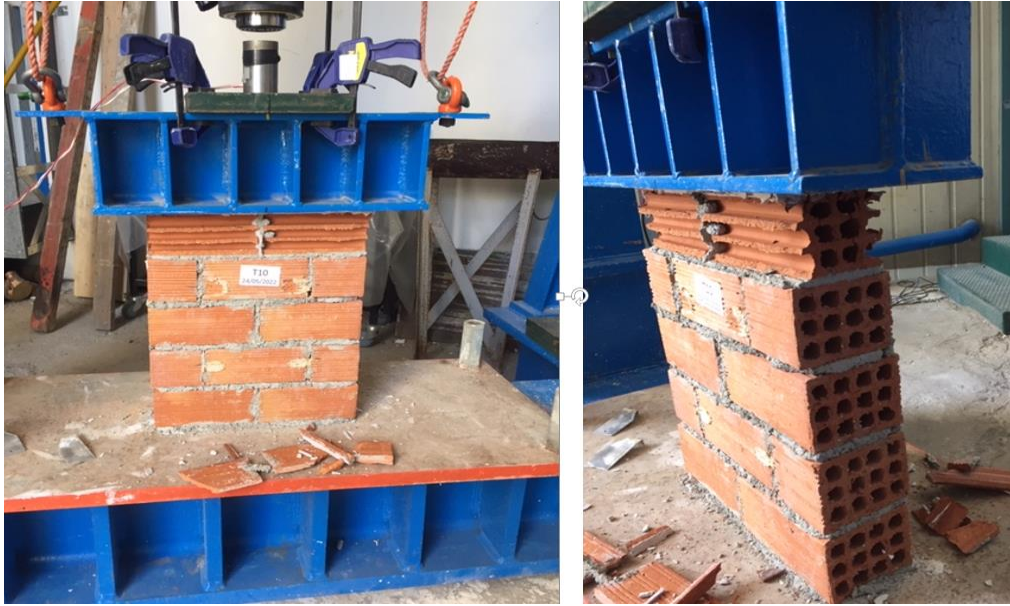
Εικόνα 5-20: Αστοχία τοίχου T10 κατά τον προσδιορισμό του μέγιστου θλιπτικού φορτίου
