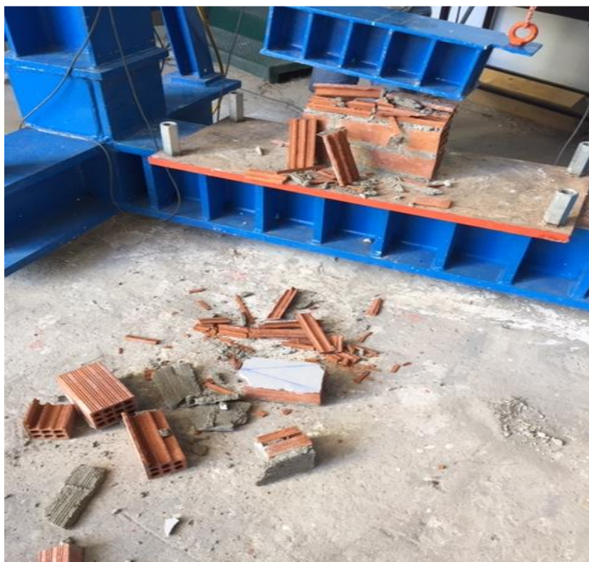
Εικόνα 5-7: Αστοχία τοίχου T24 κατά τον προσδιορισμό του μέγιστου θλιπτικού φορτίο
