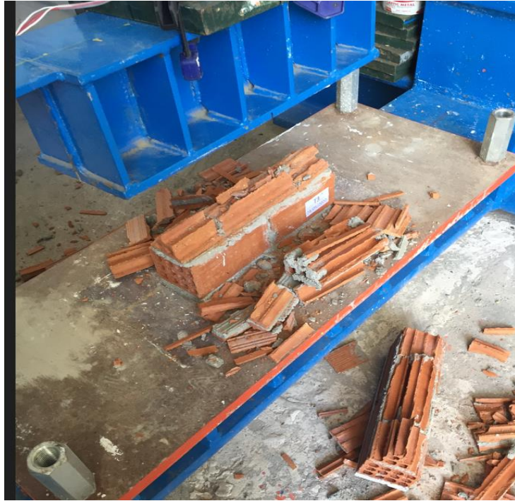
Εικόνα 5-13: Αστοχία τοίχου T3 κατά τον προσδιορισμό του μέγιστου θλιπτικού φορτίου
