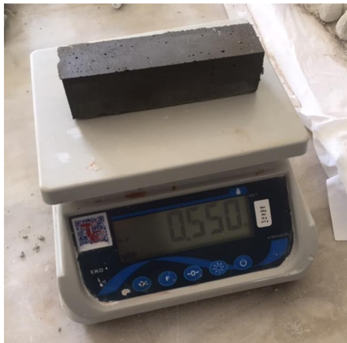
Εικόνα 2-5: Δοκίμιο κονιάματος δόμησης
