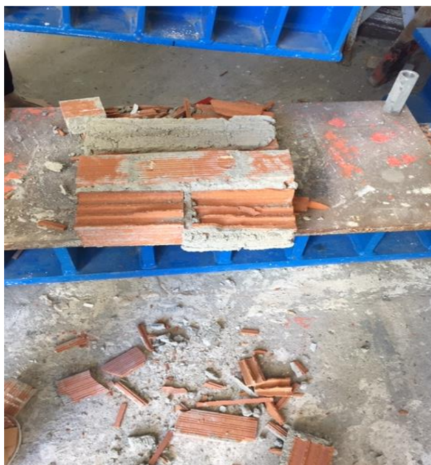
Εικόνα 5-8: Αστοχία τοίχου T19 κατά τον προσδιορισμό του μέγιστου θλιπτικού φορτίο
