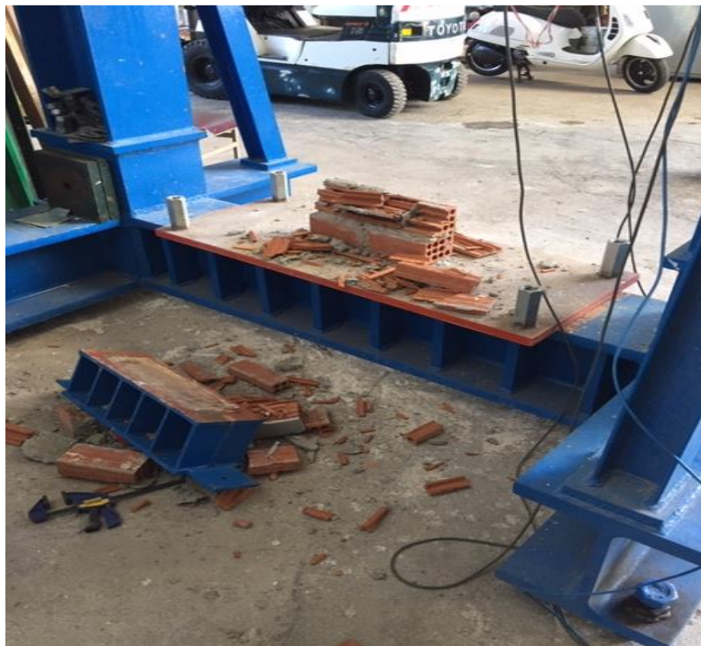
Εικόνα 5-9: Αστοχία τοίχου T20 κατά τον προσδιορισμό του μέγιστου θλιπτικού φορτίου
