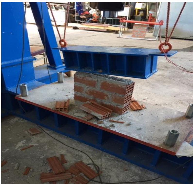
Εικόνα 5-5: Αστοχία τοίχου T18 κατά τον προσδιορισμό του μέγιστου θλιπτικού φορτίο
