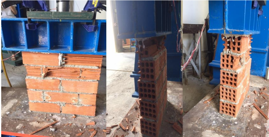
Εικόνα 5-21: Αστοχία τοίχου T12 κατά τον προσδιορισμό του μέγιστου θλιπτικού φορτίου
