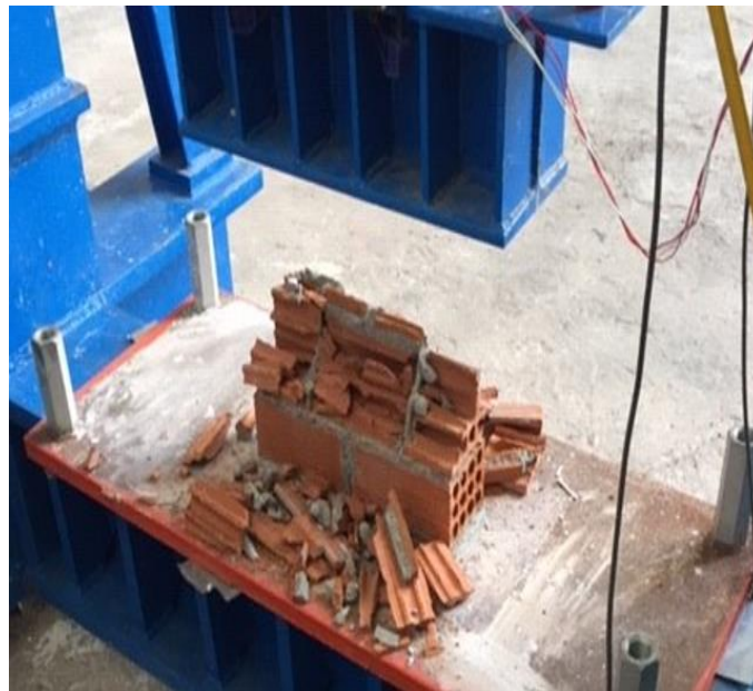
Εικόνα 5-18: Αστοχία τοίχου T8 κατά τον προσδιορισμό του μέγιστου θλιπτικού φορτίο
