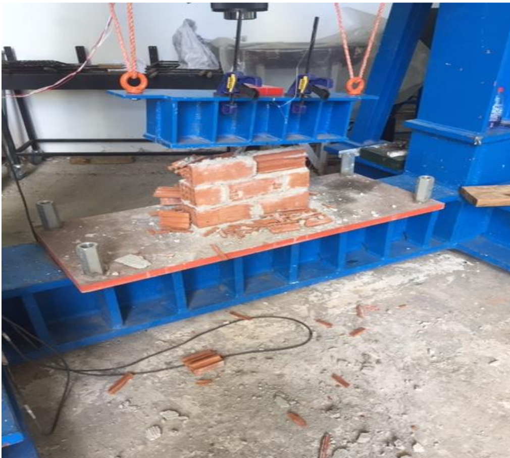
Εικόνα 5-1: Αστοχία τοίχου T13 κατά τον προσδιορισμό του μέγιστου θλιπτικού φορτίου
