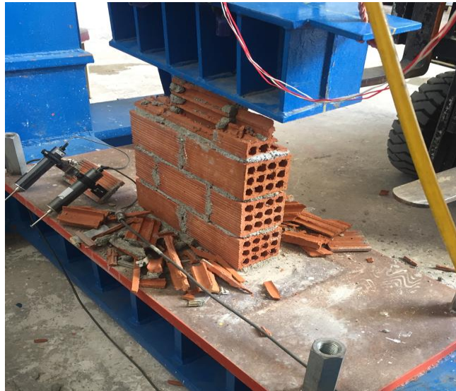
Εικόνα 5-12: Αστοχία τοίχου T2 κατά τον προσδιορισμό του μέγιστου θλιπτικού φορτίου
