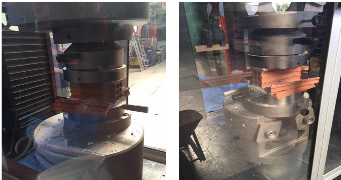
Εικόνα 2-4: Αστοχία δοκιμών οπτόπλινθων υπό την εφαρμογή του θλιπτικού φορτίου
