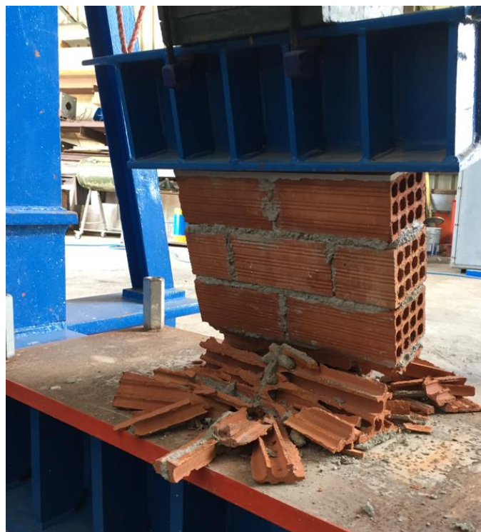
Εικόνα 5-11: Αστοχία τοίχου T1 κατά τον προσδιορισμό του μέγιστου θλιπτικού φορτίου
