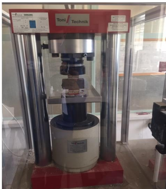
Εικόνα 2-7: Δοκιμή μονοαξονικής θλίψης
