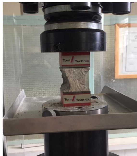
Εικόνα 2-7: Δοκιμή μονοαξονικής θλίψης
