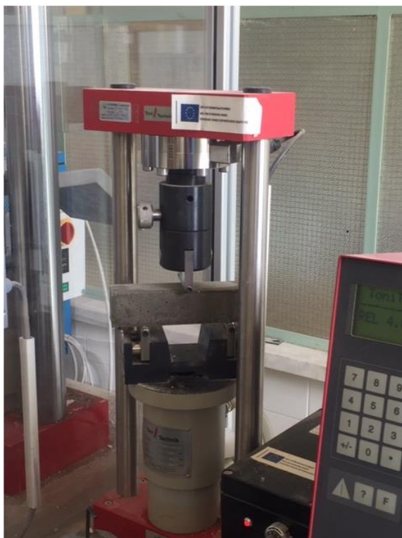
Εικόνα 2-6: Κάμψη τριών σημείων σε δοκίμια κονιάματος δόμησης
