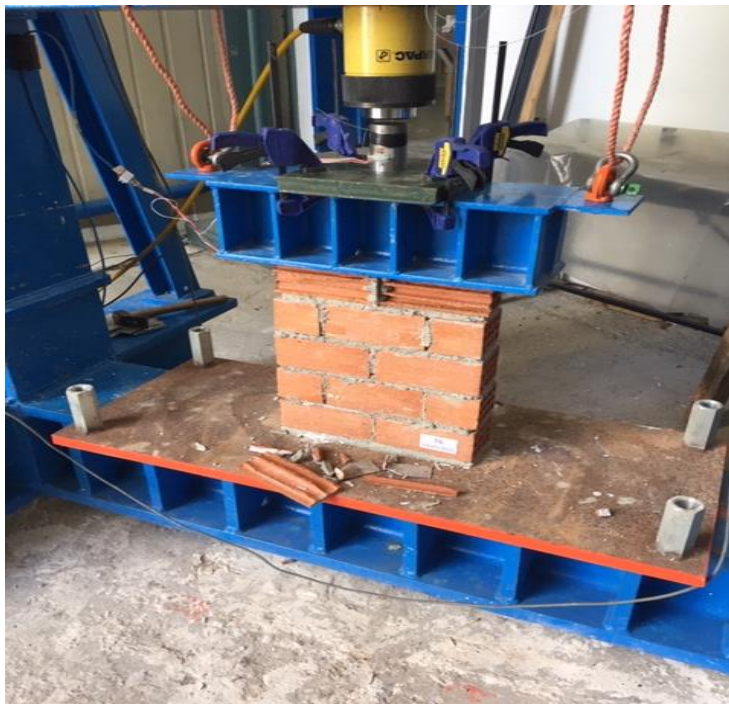
Εικόνα 5-17: Αστοχία τοίχου T6 κατά τον προσδιορισμό του μέγιστου θλιπτικού φορτίου
