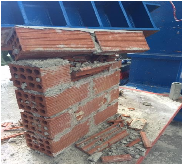
Εικόνα 5-2: Αστοχία τοίχου T15 κατά τον προσδιορισμό του μέγιστου θλιπτικού φορτίου
