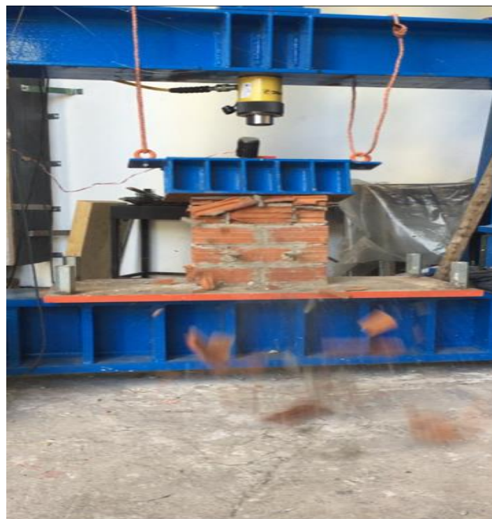
Εικόνα 5-6: Αστοχία τοίχου T23 κατά τον προσδιορισμό του μέγιστου θλιπτικού φορτίου
