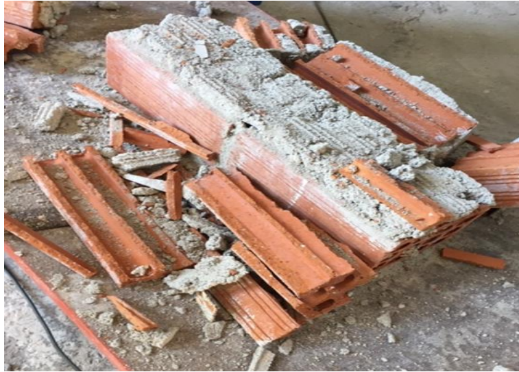
Εικόνα 5-3: Αστοχία τοίχου T16 κατά τον προσδιορισμό του μέγιστου θλιπτικού φορτίου
