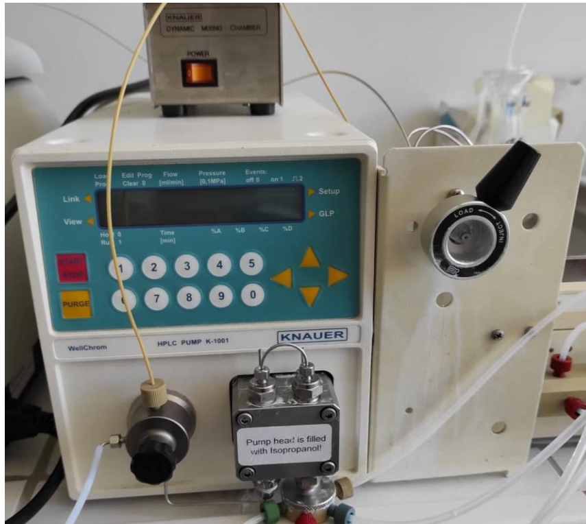
Εικόνα 9: Η αντλία KNAUER, ο θάλαμος ανάμειξης πάνω στην αντλία καθώς και το σημείο που εισάγεται η ένεση με την φαρμακευτική ένωση υπό εξέταση.
