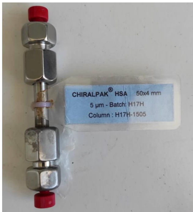
Εικόνα 12: Η στήλη HSA της εταιρείας CHIRAL που χρησιμοποιήθηκε.
