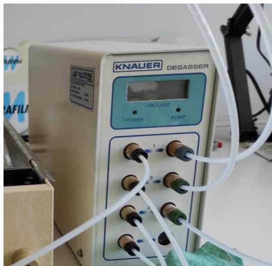
Εικόνα 8: Ο απαερωτής της εταιρίας KNAUER που χρησιμοποιήθηκε. Κατά την διάρκεια της πειραματικής διαδικασίας είναι σημαντικό να μην υπάρχουν φυσαλίδες στο σύστημα, κάτι στο οποίο συμβάλει ο απαερωτής καθώς αφαιρεί τις φυσαλίδες από το σωληνάκι με το οποίο εισάγεται η κινητή φάση στο χρωματογραφικό σύστημα.
