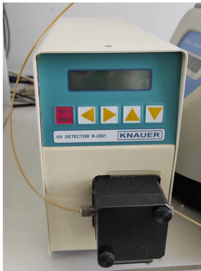
Εικόνα 10: Η συσκευή ανίχνευσης UV της εταιρίας KNAUER, η οποία είναι συνδεδεμένη με υπολογιστή για την δημιουργία του χρωματογραφήματος.
