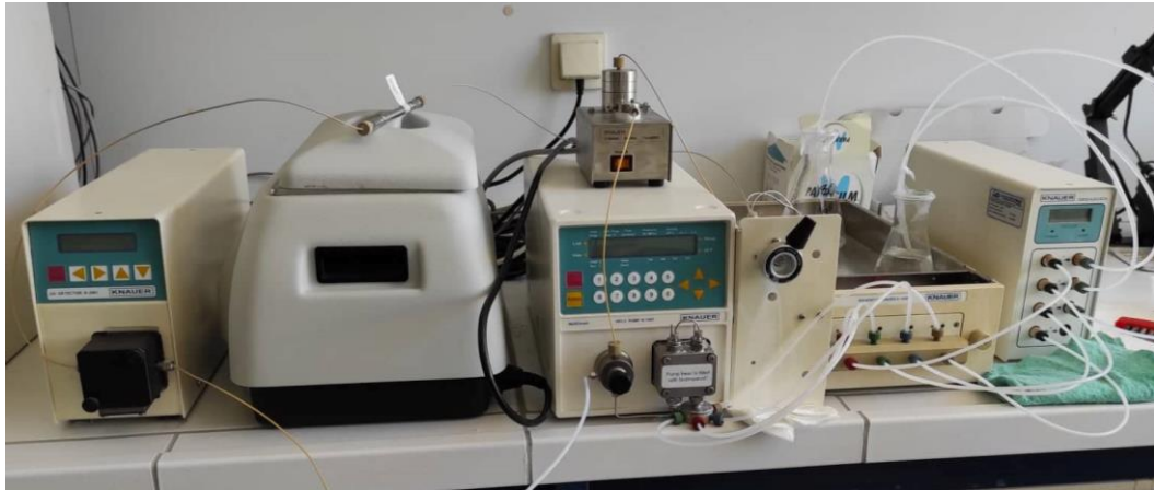
Εικόνα 7: Το σύστημα HPLC της εταιρίας KNAUER που χρησιμοποιήθηκε για την εκπόνηση της παρούσας διπλωματικής εργασίας.
