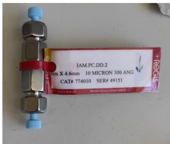
Εικόνα 11: Η στήλη IAM.PC.DD.2 της εταιρείας REGIS που χρησιμοποιήθηκε.
