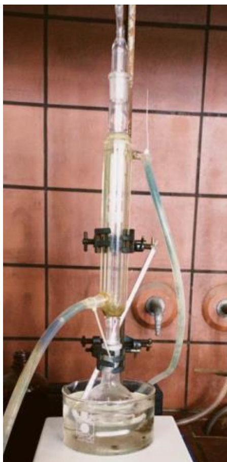
Εικόνα 2-1: Πειραματική διάταξη παρασκευής NaDES με ελεγχόμενη θέρμανση, κάθετο ψυκτήρα και μαγνητική ανάδευση
