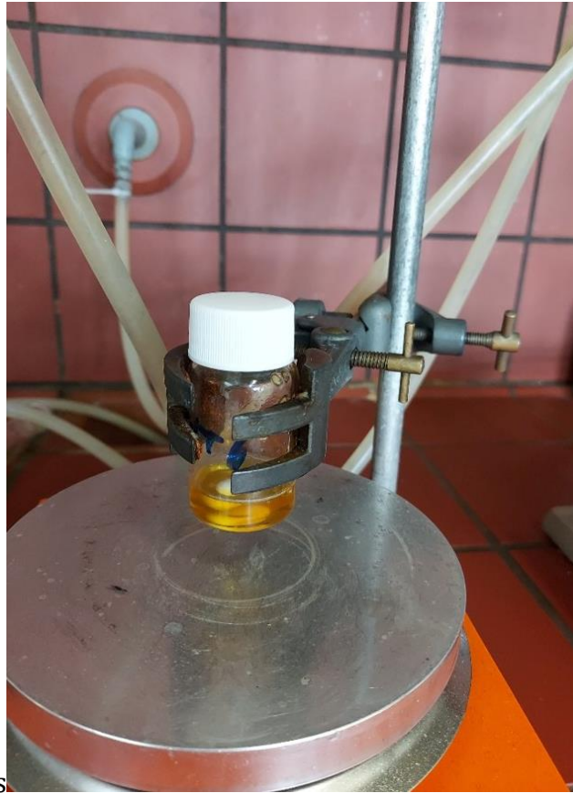
Εικόνα 2-3: Πειραματική διάταξη παρασκευής υδρογέλης χιτοζάνης με NaDES
