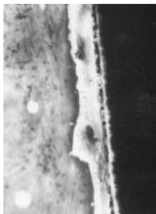
ΣΧΗΜΑ 8.16. Μικροσκοπική μικρογραφία λευκού φωτός μιας διεπιφάνειας οστού – λείου cpTi με παρέμβαση στρώματος από λεπτό συνδετικό ιστό. Αυτό το εμφύτευμα είναι κινητό από χειρουργικής πλευράς εξαιτίας της έλλειψης ανάπτυξης του ιστού. (Μεγέθυνση = 50x).
