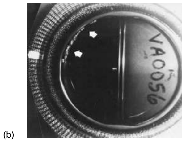
ΣΧΗΜΑ 7.5. Φυσαλίδες σπηλαιώσης που φαίνονται στην πλευρά της ροής εισόδου βαλβίδων in vitro. (a) Medtronic – Hall tilting disk valve. (b) Bileaflet βαλβίδα Edwards – Duromedics.
