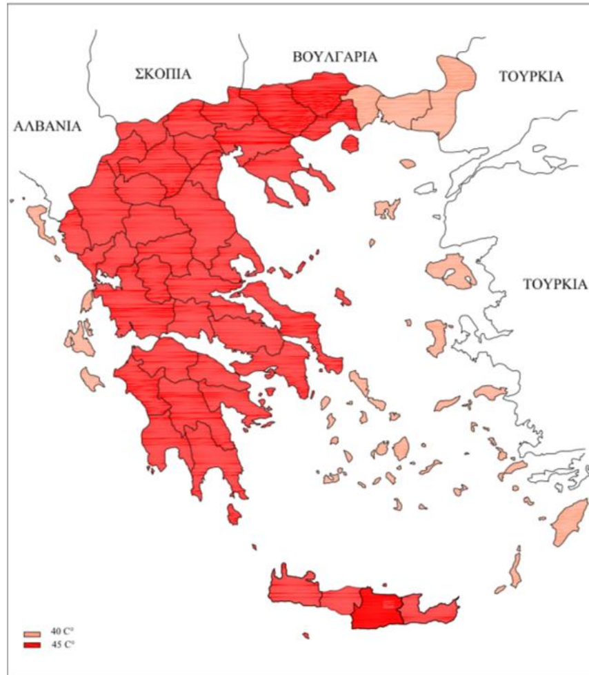
Σχήμα 3-13 Χάρτης μέγιστων θερμοκρασιών αέρα υπό σκιά T_{max}
