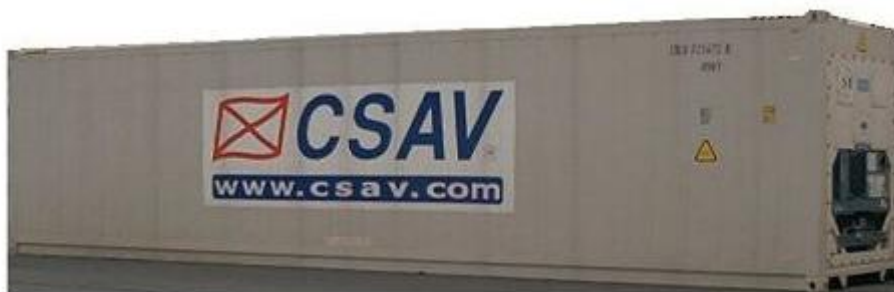
Σχήμα 2.1.24: Θερμικό εμπορευματοκιβώτιο με ενσωματωμένη μονάδα ψύξης Πηγή: (1)
