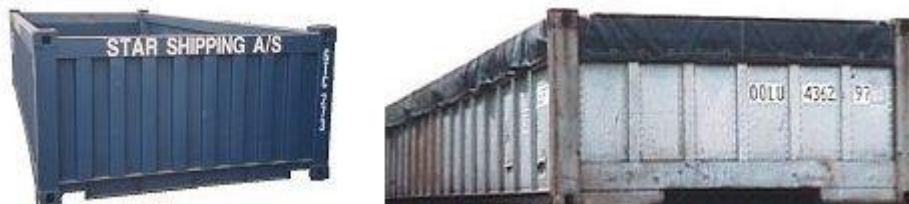
Σχήμα 2.1.32: Εμπορευματοκιβώτια ανοικτής 20' και 40', με και χωρίς κάλυμμα Πηγή: (1)
