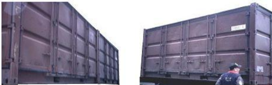
Σχήμα 2.1.4: Εμπορευματοκιβώτια με ανοίγματα στα δύο άκρα, αλλά και πλήρως ανοιγόμενα πλευρικά ανοίγματα.
