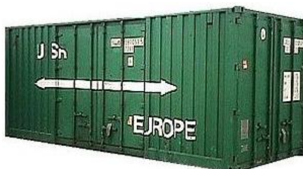
Σχήμα 2.1.9: Εμπορευματοκιβώτιο 20'x8'6" με πλευρικές πόρτες. Πηγή: (1)
