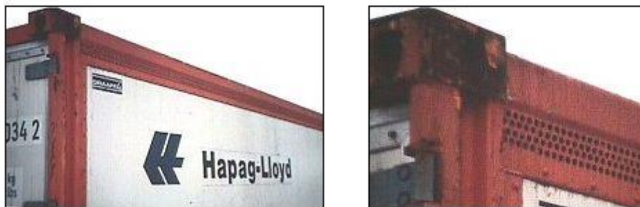
Σχήμα 2.1.14: Εμπορευματοκιβώτιο γενικού σκοπού με μη-μηχανικό εξαερισμό Πηγή: (1)
