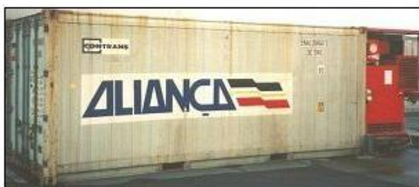
Σχήμα 2.1.29: Θερμικό μονωμένο εμπορευματοκιβώτιο με εξωτερική μονάδα παροχής ενέργειας
