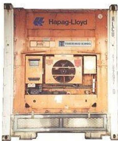
Σχήμα 2.1.27: Ολοκληρωμένο σύστημα ψύξης/θέρμανσης για σύνδεση προς παροχή ενέργειας στη ξηρά ή στο πλοίο
