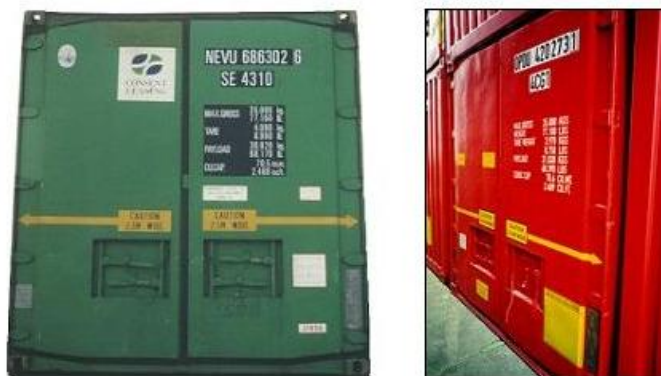
Σχήμα 2.1.8: Εμπορευματοκιβώτια 40' συμβατά με παλέτες. Πηγή: (1)
