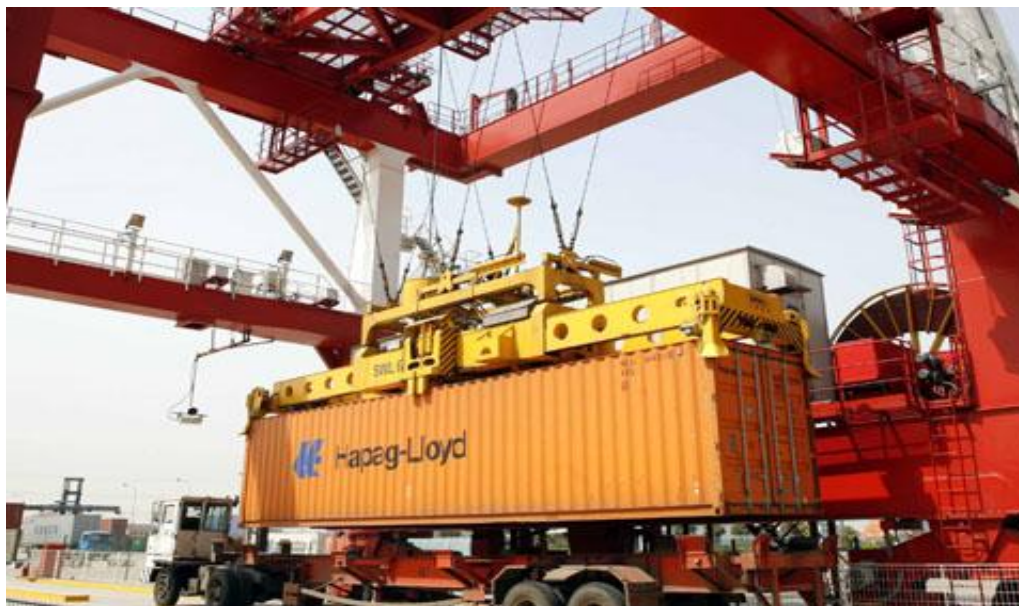
Σχήμα 3.3.7: Χρήση ανεστραμμένων τριγωνικών συστημάτων ανάρτησης για την μείωση των ταλαντώσεων
