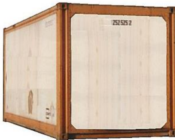
Σχήμα 2.1.3: Εμπορευματοκιβώτιο 20' με ξύλινα τοιχώματα και οπές εξαερισμού στο άνω μεταλλικό πλευρικό πλαίσιο.
