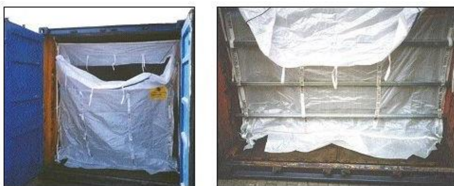
Σχήμα 2.1.22: Εσωτερικές επενδύσεις σε εμπορευματοκιβώτιο γενικού σκοπού για μεταφορά χύδην φορτίου
