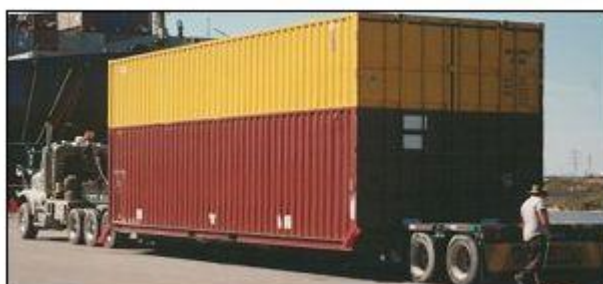
Σχήμα 2.1.13: Εμπορευματοκιβώτιο πλάτους γενικού σκοπού πλάτους 10' Πηγή: (1)
