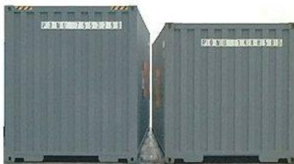
Σχήμα 2.1.6: Σύγκριση μεγάλου ύψους εμπορευματοκιβωτίου (9'6") με εμπορευματοκιβώτιο των 8'6".
