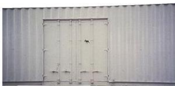
Σχήμα 2.1.12: Εμπορευματοκιβώτιο γενικού σκοπού ειδικά σχεδιασμένο με πλευρικές πόρτες
