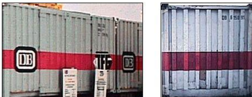
Σχήμα 2.1.10: Εμπορευματοκιβώτιο 20' και πλάτους 2,50μ. χρησιμοποιούμενο για εσωτερικές μεταφορές από τους Γερμανικούς Σιδηροδρόμους Πηγή: (1)
