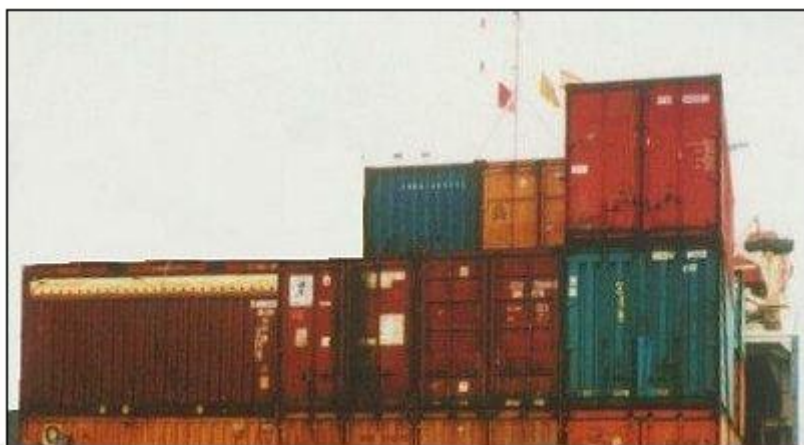
Σχήμα 2.2. 14: Εμπορευματοκιβώτια στοιβαγμένα και στις δύο διευθύνσεις Πηγή: (1)
