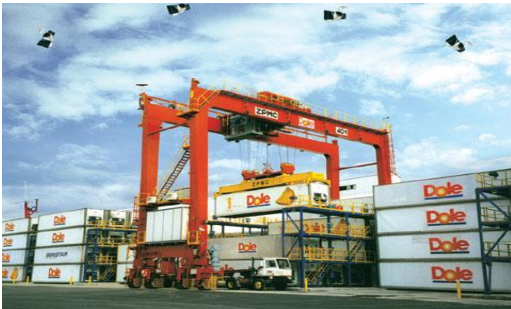
Σχήμα 3.3.6: Μεγάλη ακρίβεια στη στοιβασία λόγω χρήσης συστήματος GPS Πηγή: (17)
