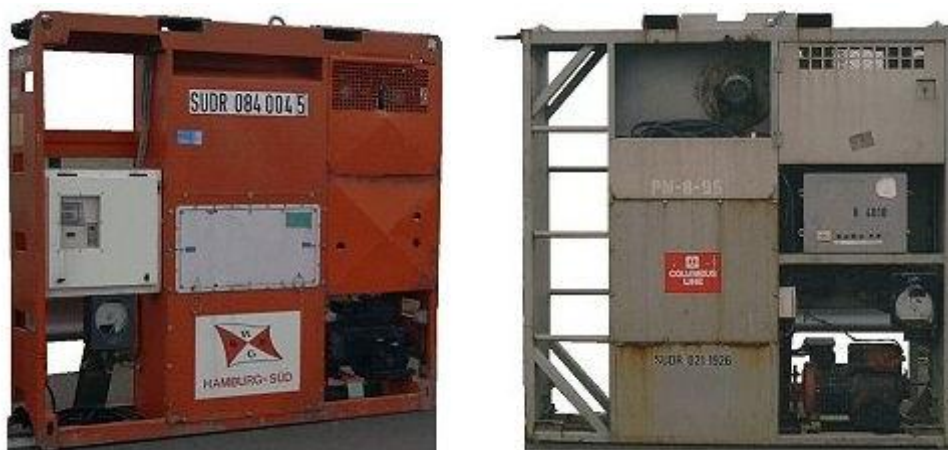
Σχήμα 2.1.28: Μονάδες προσαρμοζόμενες προσωρινά σε θερμικά εμπορευματοκιβώτια
