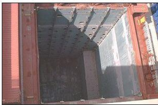
Σχήμα 2.2.15: Ασφάλιση εμπορευματοκιβωτίων με κυψέλες οδηγούς Πηγή: (1)
