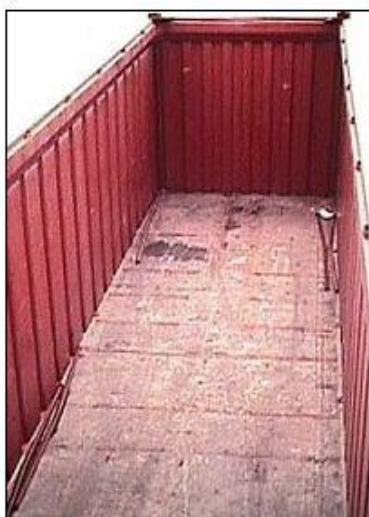
Σχήμα 2.1.31: Εμπορευματοκιβώτιο ανοικτής οροφής χωρίς κάλυψη οροφής
