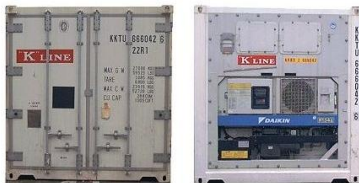
Σχήμα 2.1.25: Θερμικό εμπορευματοκιβώτιο 20'x8'6" ψυχόμενο/θερμαινόμενο μηχανικά
