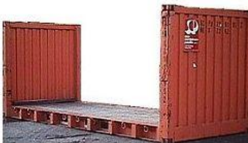
Σχήμα 2.1.34: Πλατφόρμα τύπου flatrack μήκους 20' με σταθερά τοιχώματα στα άκρα
