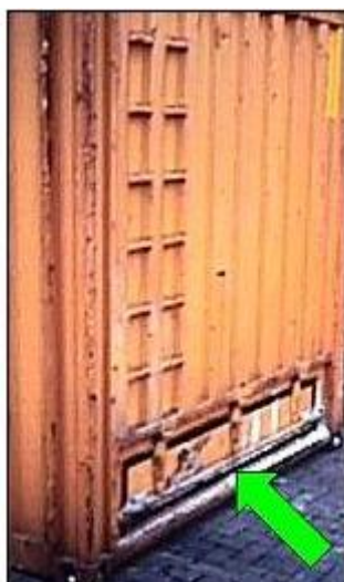
Σχήμα 2.1.18: Εμπορευματοκιβώτιο ξηρού χύδην φορτίου με θυρίδα εκκένωσης Πηγή: (1)
