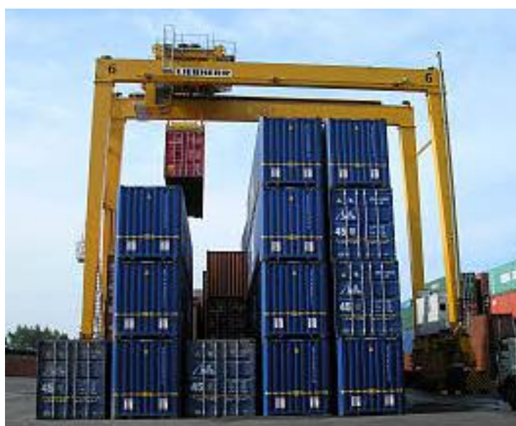
Σχήμα 3.3.1: Γερανογέφυρα επί ελαστικών τροχών
