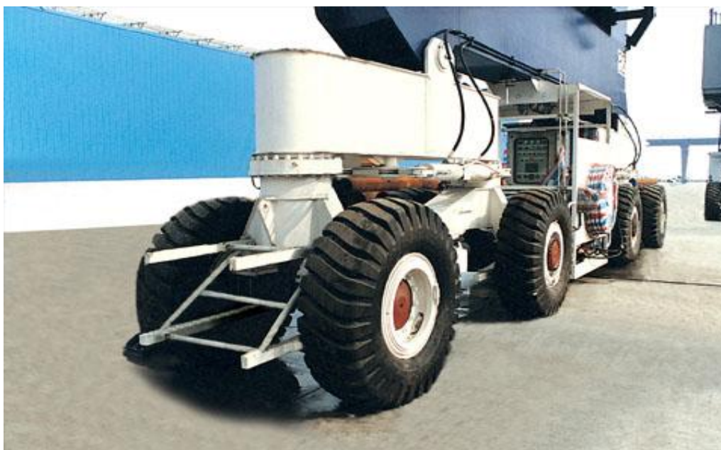
Σχήμα 3.3.9: Γερανογέφυρα RTG με 16 τροχούς Πηγή: (17)
