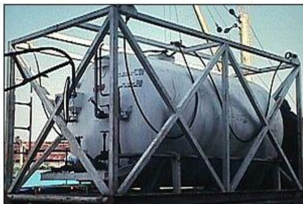
Σχήμα 2.1.36: Εμπορευματοκιβώτιο-βυτίο μεταφοράς μη επικίνδυνων υγρών Πηγή: (1)
