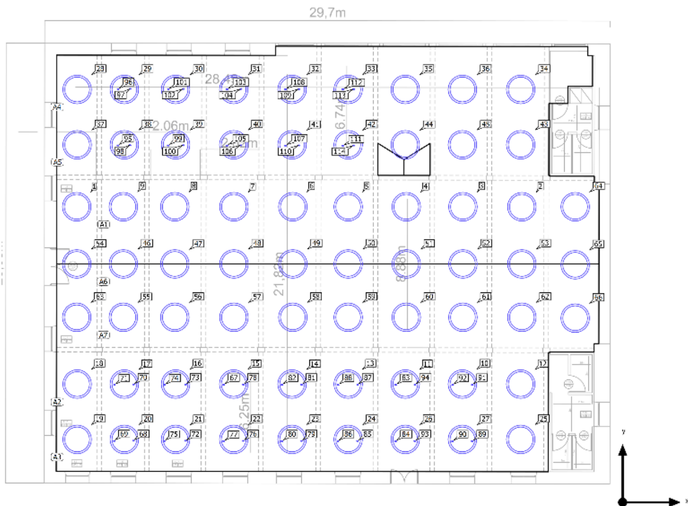
Εικόνα 6.25: Κάτοψη σχεδίου θέσης φωτιστικών στο λογισμικό DIALux eno, «Κεντρική Σάλα» [Ίδια Επεξεργασία].
