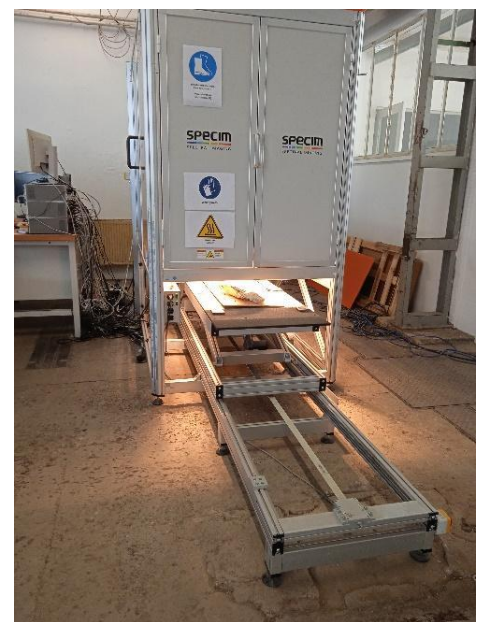
Εικόνα 4-3: Αισθητήρας Sisurock στις εγκαταστάσεις του HIF
