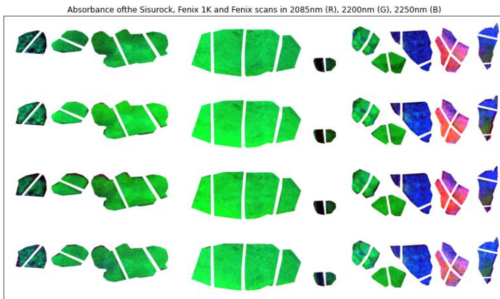
Εικόνα 6-9: Απεικόνιση με ψευδο-χρωματική εικόνα για απορροφήσεις στα 2085 nm (R), 2200 nm (G), 2250 nm (B) αντίστοιχα για τις εργαστηριακές λήψεις από 4 διαφορετικούς αισθητήρες (SiSuRock, Fenix1K, Fenix, Mjolnir)
