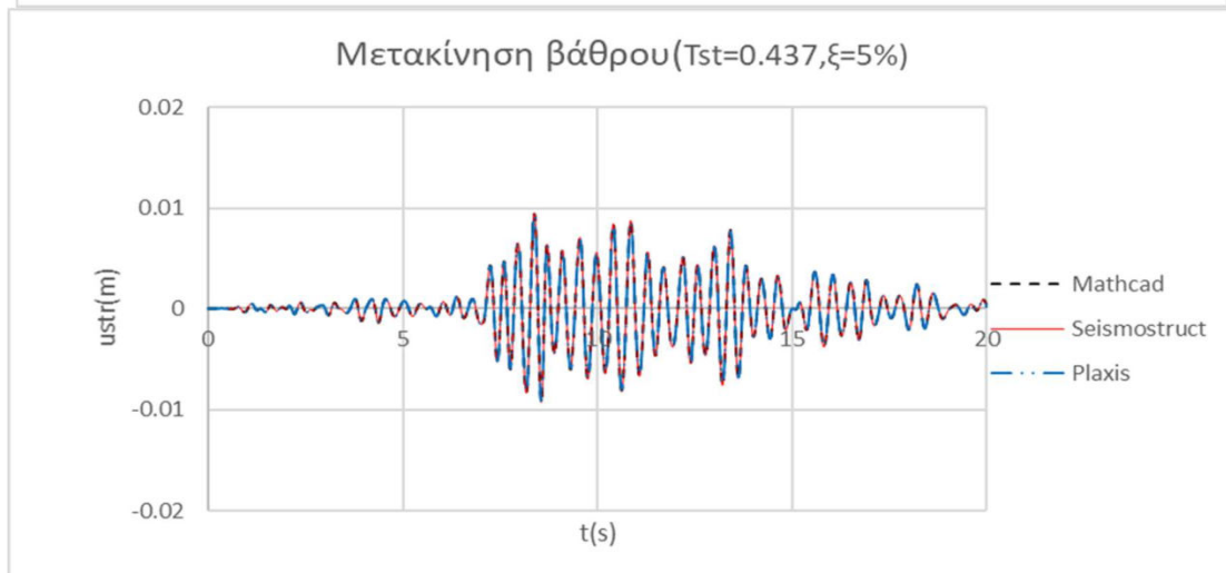
Σχήμα 3.12 Επιτάχυνση στην μάζα και μετακίνηση βάρους του ταλαντωτή για το σεισμό Trinidad
