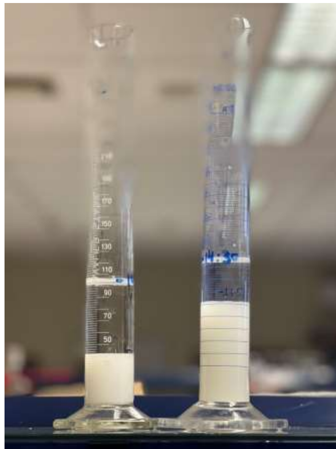
Εικόνα 6.1: Προσθήκη NaOH με ψεκασμό (αριστερά) και χωρίς ψεκασμό (δεξιά)
