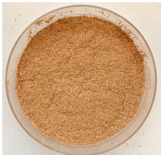
Εικόνα 11: Σκουρόχρωμη (κόκκινη) βύνη, μικρής κοκκομετρίας (<1mm)
