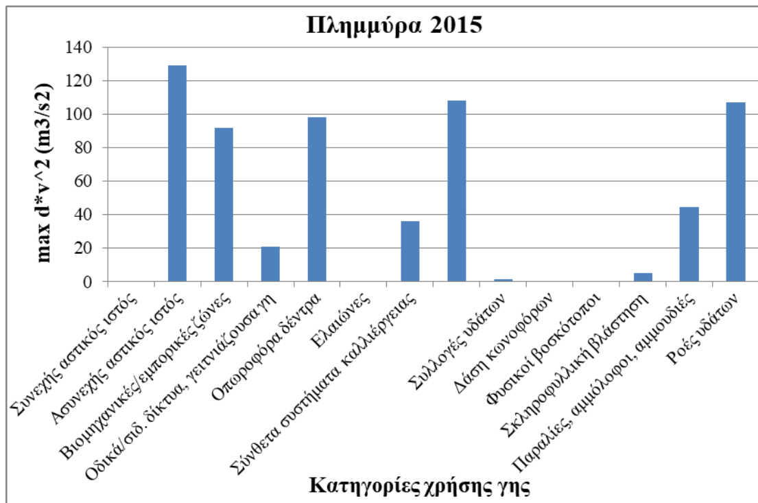
Σχήμα A 14: Γράφημα d \cdot v^2 ανά κατηγορία χρήσης γης της πλημμύρα του 2015
