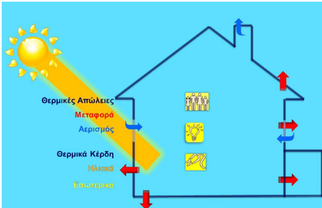
ΕΙΚΟΝΑ 16 - ΣΚΑΡΙΦΗΜΑ ΡΟΗΣ ΕΝΕΡΓΕΙΑΣ ΣΤΗΝ ΚΤΗΡΙΑΚΗ ΕΓΚΑΤΑΣΤΑΣΗ
