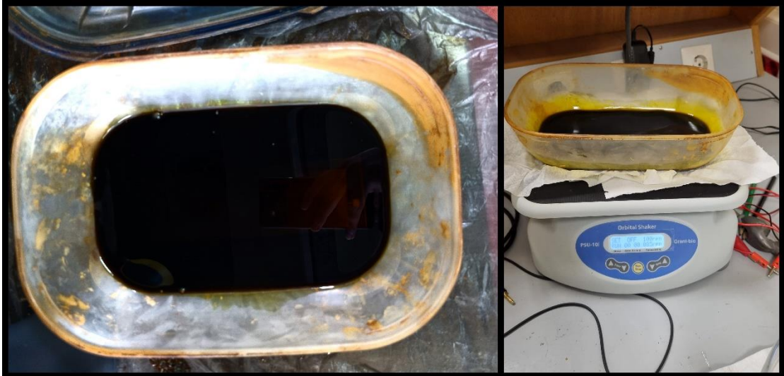
Εικόνα 29 : Τοποθέτηση διαλύματος του τριχλωριούχου σιδήρου πάνω στον αναδευτήρα (Orbital shaker PSU – 10i Grand – bio) .
