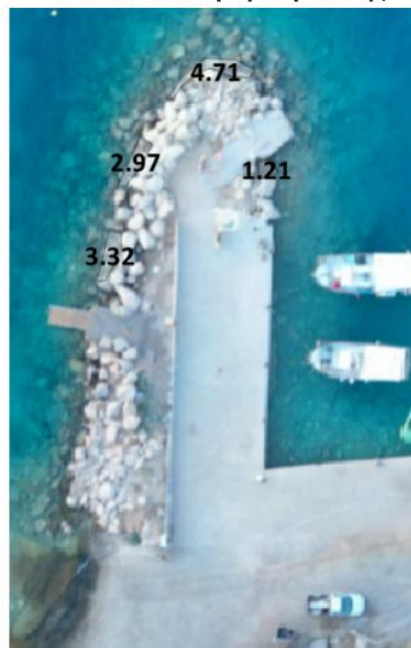
Εικόνα 6.20 Μετακίνηση θωράκισης στο αλιευτικό καταφύγιο Αγίου Βασιλείου (ΤΕΞ2)
