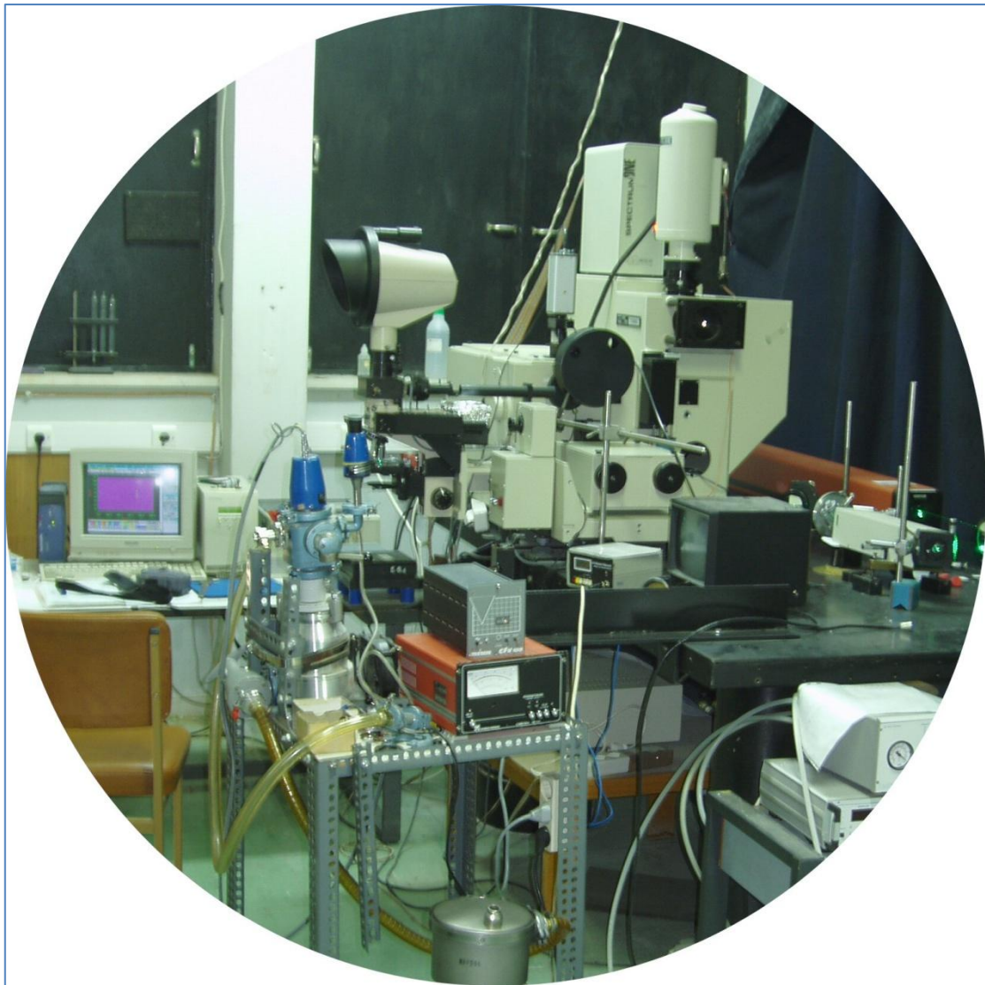
Σχήμα 2.12 : Πειραματική διάταξη micro Raman που χρησιμοποιήθηκε.
