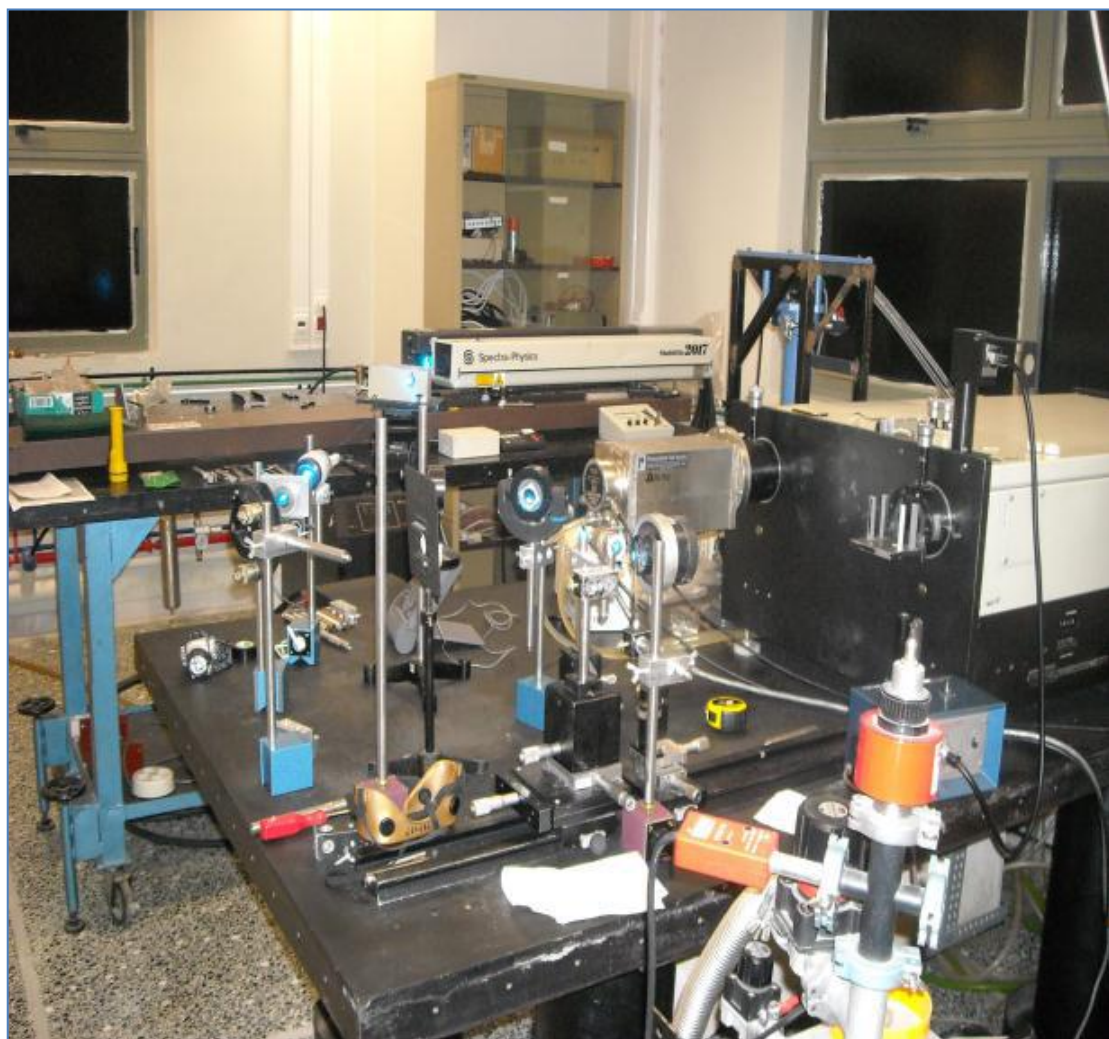
Σχήμα 2.11 : Πειραματική διάταξη macro Raman που χρησιμοποιήθηκε.
