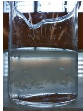
Εικ. 105. Σκληρή γέλη άγαρ που δεν είχε διατηρηθεί σε νερό εμβάπτιση για 24h σε αιθανόλη. Διαφοροποίηση στη μάζα της σκληρής γέλης.
