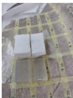
Εικ.107. (Αμα). Σκληρή γέλη άγαρ με και χωρίς πρόσθετο βάρος. 2% w/v (δεξιά) και 4% w/v (αριστερά)
