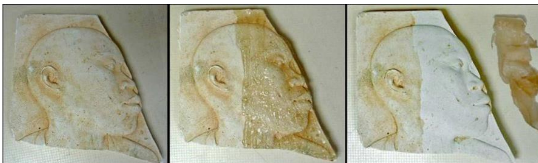
Εικ.31. Πριν, κατά και μετά την χρήση σκληρής γέλης άγαρ 2%w/v για 20min σε γύψο με επιφανειακή ακαθαρσία και υπολείμματα από πηλό [32].
