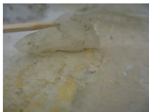
Εικ.29. Κατά την αφαίρεση σκληρής γέλης άγαρ μετά από 30min εφαρμογής [13].
