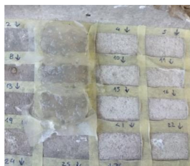
Εικ. 108. (Αμα). Κατά την εφαρμογή ημίρρευτης γέλης άγαρ 2% w/v με νερό (για 10, 20 και 30 min).
