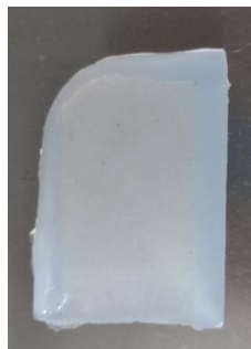
Εικ. 101. Σκληρή γέλη άγαρ χωρίς διαλύτες, 4% w/v.
