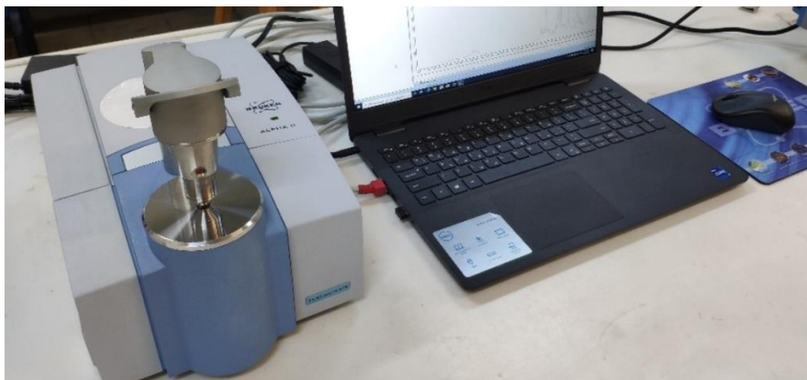
Εικ. 59. Φασματοσκοπία Υπερύθρου με την τεχνική της αποσβένουσας ολικής ανάκλασης (Attenuated Total Reflectance Fourier Transform Infrared Spectroscopy, ATR-FTIR. Μοντέλο Alpha II με το Diamond ATR accessory της εταιρίας Bruker.
