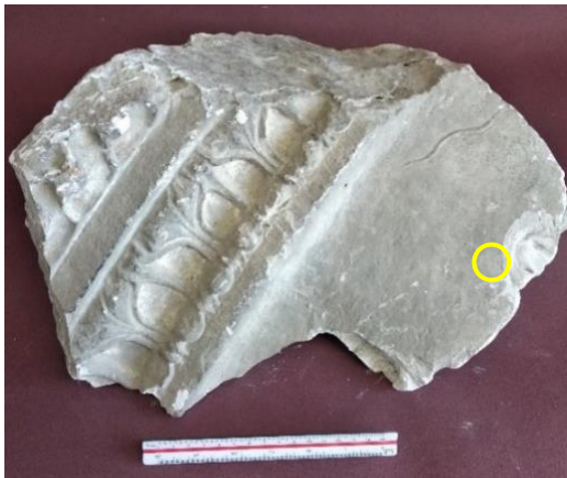
Εικ. 68. (Ama). Περιοχή δειγματοληψίας για FTIR-ATR και για Raman.
