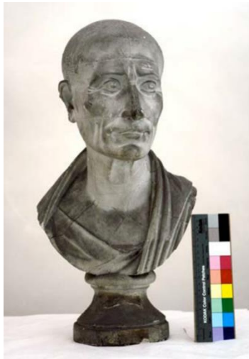
Εικ.18. Γύψινη προτομή του Ιουλίου Καίσαρα εμφανίζει έντονες επικαθίσεις και το «φαινόμενο αντίστροφης σκιάς» [2]
