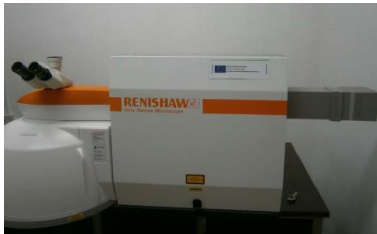
Εικ. 60. Φασματοσκοπία Raman. Renishaw inVia reflex Raman microscope.
