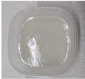
α. Σκληρή γέλη άγαρ με διαλύτη μέσα στη μάζα της, μετά την σκλήρυνσή της.
