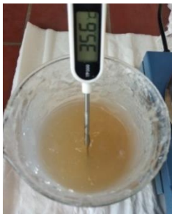
α. Παρασκευή ακατάλληλης γέλης άγαρ με απότομη θέρμανση
