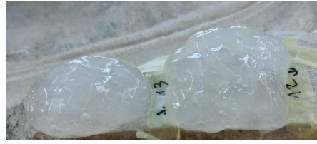
Εικ. 115. Εφαρμογή κόμμεως ξανθάνης με αιθανόλη (Xo28) αριστερά και με ισοπροπανόλη δεξιά (Xo13).
