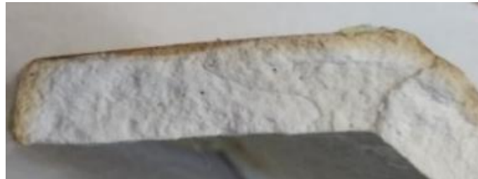
Εικ. 138. Περιοχή θραύσης του (Ko). Βάθος εισχώρησης της λαδομπογιάς. Δείχνει ότι το χρώμα της λαδομπογιάς έχει εισχωρήσει σε βάθος.
