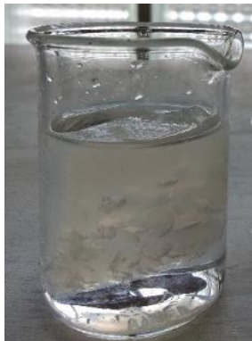
Εικ. 104. Σκληρή γέλη άγαρ που είχε διατηρηθεί σε νερό εμβάπτιση για 24h σε αιθανόλη. Διαφοροποίηση στη μάζα της σκληρής γέλης.
