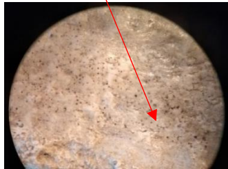
Εικ. 149. (Χο) Από στερομικροσκόπιο X 10 (στιλπνή περιοχή με σκούρες επικαθίσεις)
