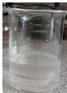
β. 3min μετά την εμβάπτιση I.( Άγαρ 2% w/v που είχε διατηρηθεί σε νερό) II. (Άγαρ2% w/v απευθείας από την παρασκευή του)
