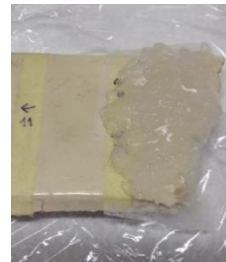
δ. Ημίρρευστη γέλη άγαρ με διαλύτη. Εφαρμογή πάνω από ιαπωνικό χαρτί
