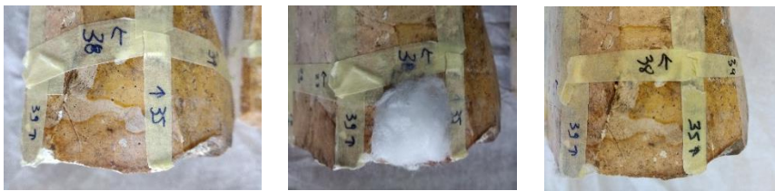
Εικ. 123. (Με 39) Επίθεμα βαμβακιού με ισοπροπανόλη για 30min.
