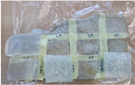
Εικ.125. Ενισχυμένο άγαρ 2% w/v με ισοπροπανόλη και αιθανόλη στη μάζα της γέλης, (Me4), (Me8) αριστερά και με εμφάπτιση με απλό άγαρ 2% w/v νερού σε αιθανόλη και ισοπροπανόλη (Me9), (Me11) δεξιά.
