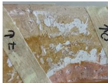
Εικ. 133. (Κ7). Λεπτομέρεια. Μετά από εφαρμογή κόμμεως ξανθάνης με αιθανόλη/W.S 2/1 για 60min.
