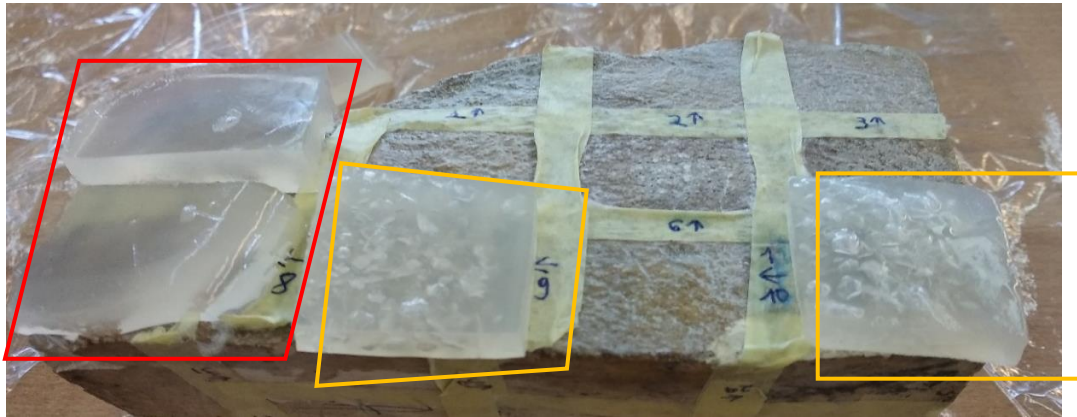
Εικ. 103. Διαφορά στη δομή της σκληρής γέλης άγαρ 2% w/v που έχει τους διαλύτες μέσα τη μάζα της κατά την παρασκευή τους (με κόκκινο), σε σύγκριση με σκληρή γέλη άγαρ 2% w/v μετά από εμβάπτιση στους ίδιους διαλύτες (με πορτοκαλί).
