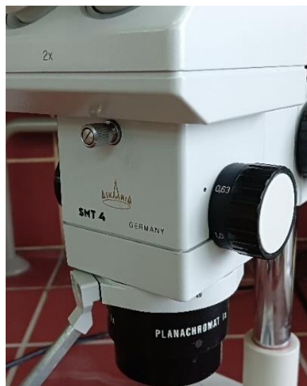
Εικ.54.Στερεομικροσκόπιο “Askania” SM4 (προέλευση Γερμανία).
