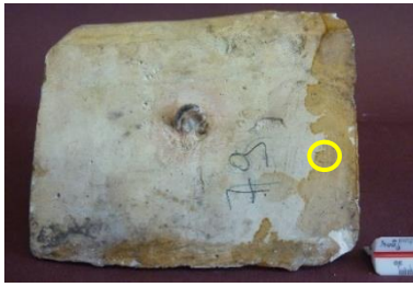
Εικ.70. (Me). Πίσω όψη. Περιοχή δειγματοληψίας για FTIR-ATR.
