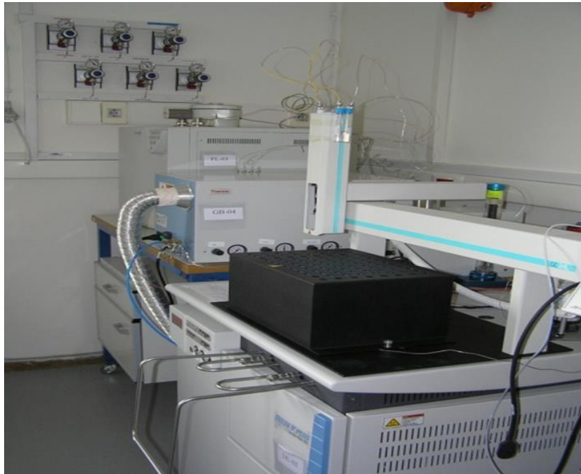
Εικόνα 4.1: Isotope Ratio Mass Spectrometer Delta V Plus από τη Thermo Scientific (εικόνα από το αρχείο του εργαστηρίου)
