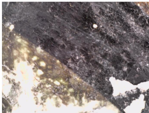
Εικόνα 38: Εικόνα DOM από σημείο μαύρης χρωματικής εντύπωσης της τοιχογραφίας αρ. 10. Διακρίνεται δίκτυο μικρορωγμών στην μαύρη περιοχή
