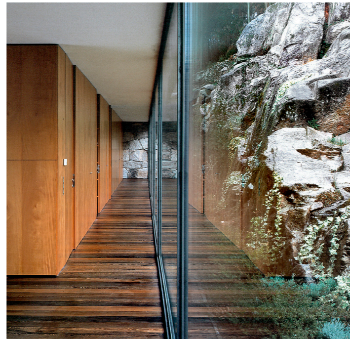
Εικ.94, 95 Σοβάς σε λευκό χρώμα, ξηρά δόμηση υπενδεδυμένη με ξύλινα πάνελ και μασίφ ξύλινο πάτωμα στο εσωτερικό της κατοικίας Moledo
