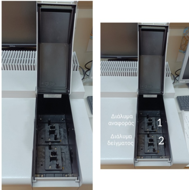
Εικόνα 19-Οι θέσεις τοποθέτησης των διαλυμάτων δείγματος και αναφοράς στο φασματοφωτόμετρο απορρόφησης Lambda 35,UV/VISSpectrometer, Perkin-Elmer
