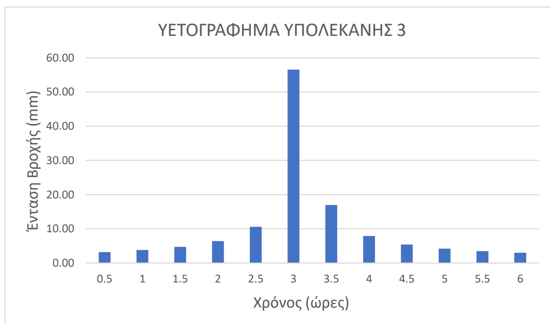
Σχήμα 3.6: Υετογράφημα υπολεκάνης 3 για T=100 χρόνια και διάρκεια βροχής 6 ωρών
