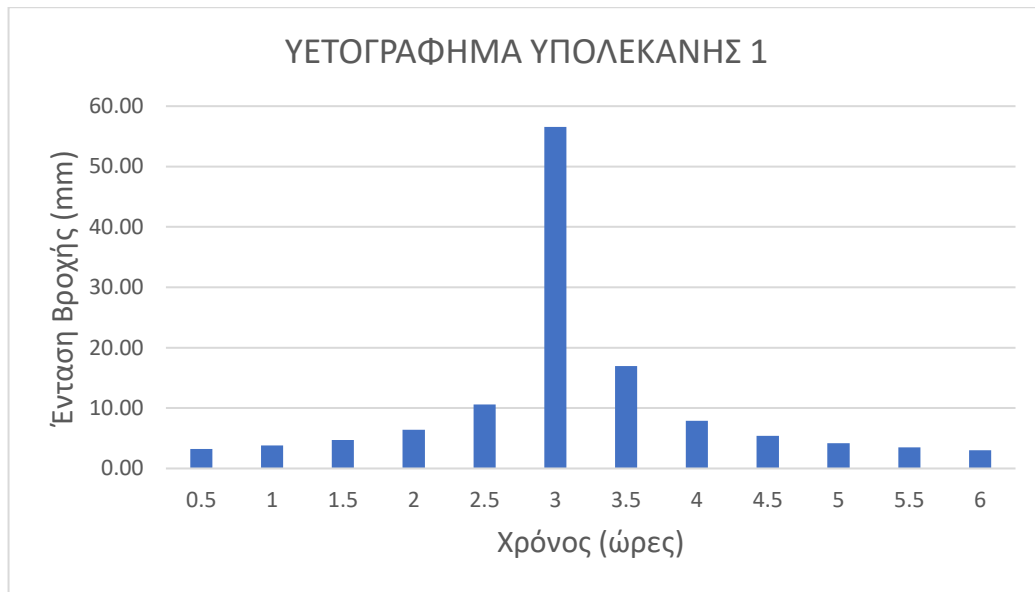
Σχήμα 3.4: Υετογράφημα υπολεκάνης 1 για T=100 χρόνια και διάρκεια βροχής 6 ωρών
