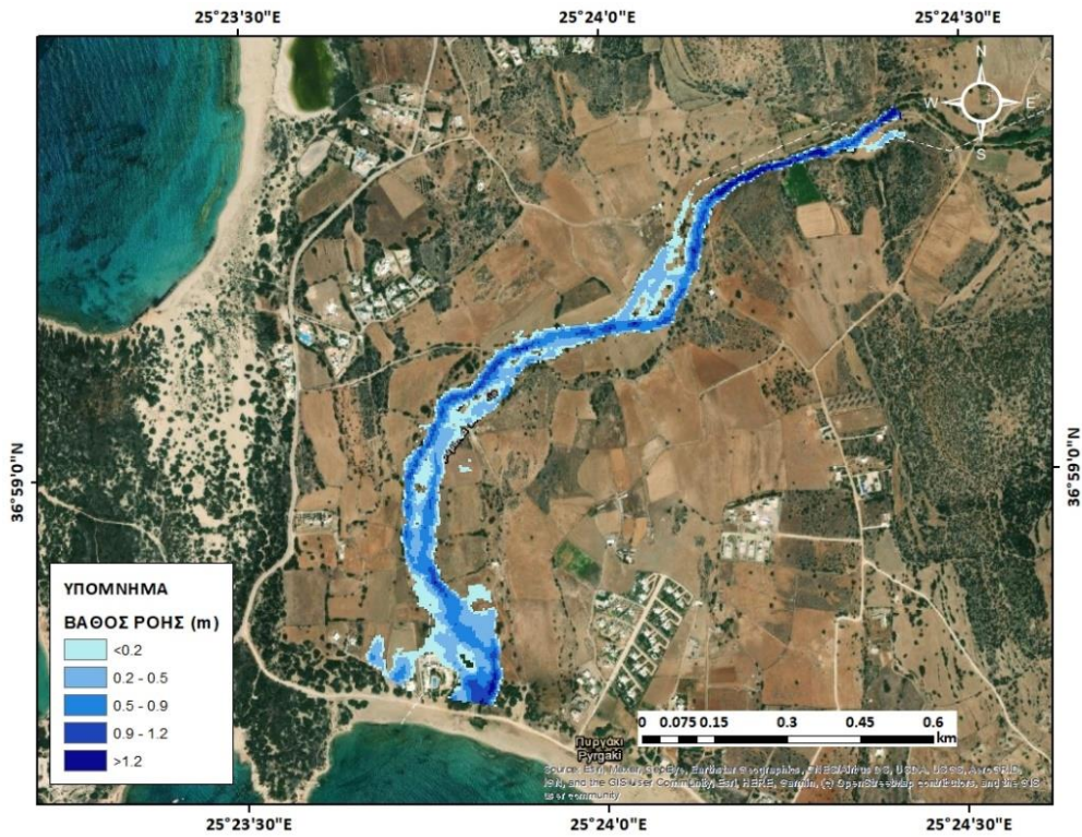
Σχήμα 4.24: Μέγιστα βάθη πεδίου πλημμύρας κατάντη της υπολεκάνης 2 με τη μέθοδο των ισόχρονων καμπυλών
