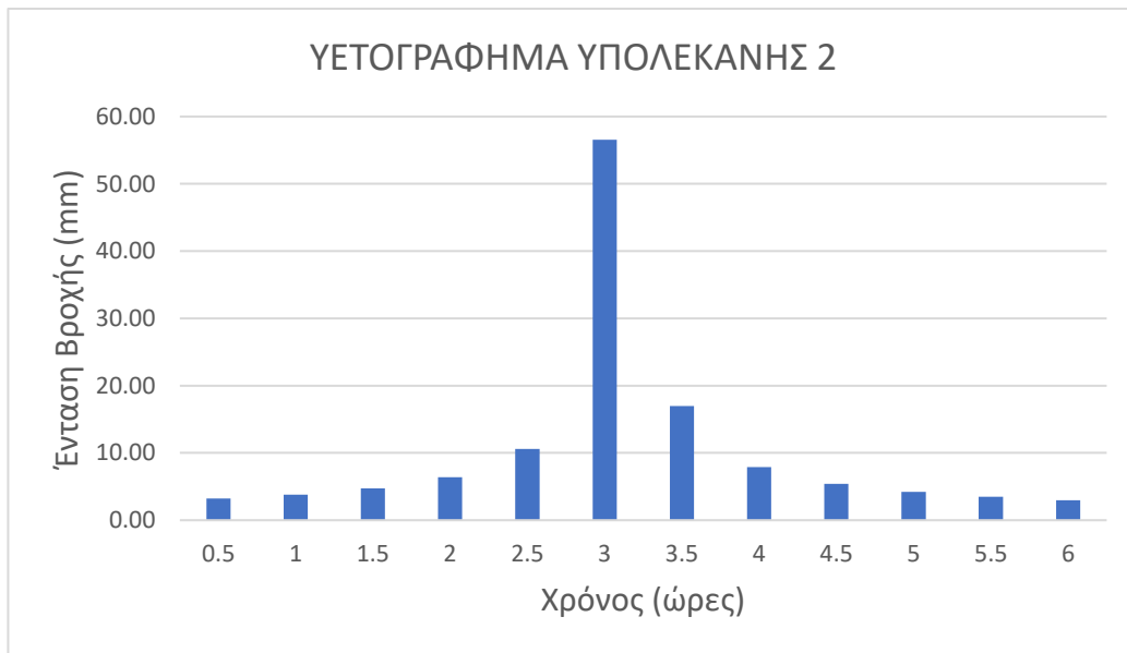
Σχήμα 3.5: Υετογράφημα υπολεκάνης 2 για T=100 χρόνια και διάρκεια βροχής 6 ωρών
