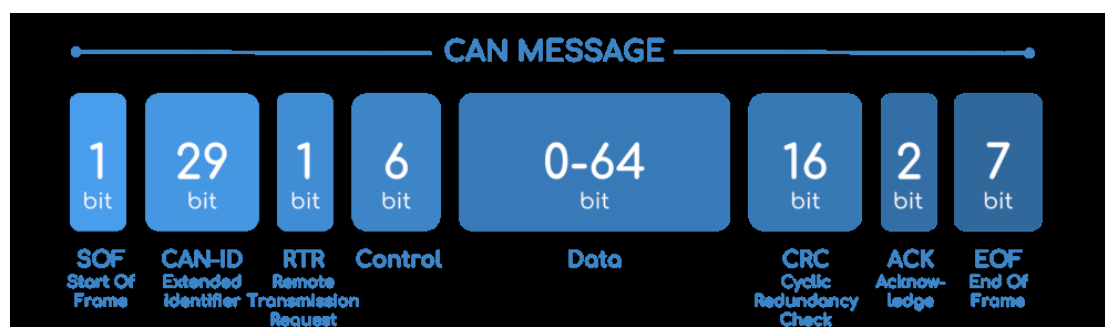
Σχήμα 1.15. Δομή μηνύματος CAN [4].
