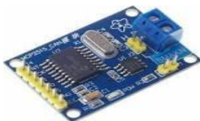
Σχήμα 4.2. MCP2515 πρακτικής εφαρμογής [30].
