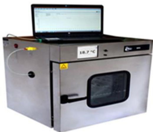
Εικόνα 3. 9 Συσκευή αυτοθέρμανσης και κυβικός δειγματοφορέας των 100mm
