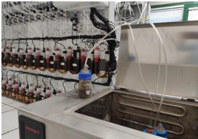
Εικόνα 3. 12 Πειραματική διάταξη για ποσοτικό προσδιορισμό εκλυόμενων αερίων ‘κλικογράφος’
