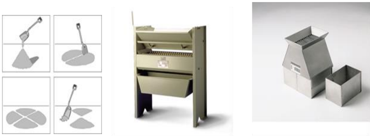
Εικόνα 3. 2 Χειροκίνητος διαχωρισμός, τετρατεμαχιστής με μεταβλητά και σταθερά ανοίγματα
