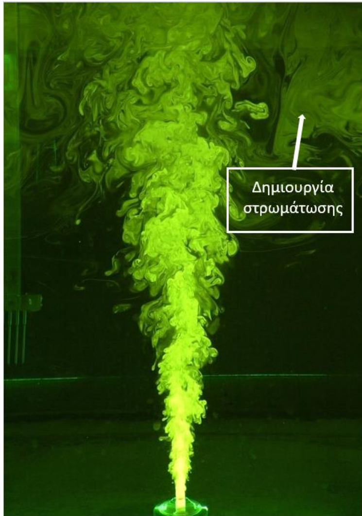
Σχήμα 3.19 Δημιουργία στρωμάτωσης εξαιτίας της θερμοκρασιακής διαφοράς μεταξύ αποδέκτη και φλέβας
