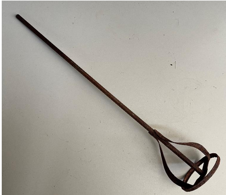
Σχήμα 3.5 Μεταλλικός αναδευτήρας κύριας δεξαμενής
