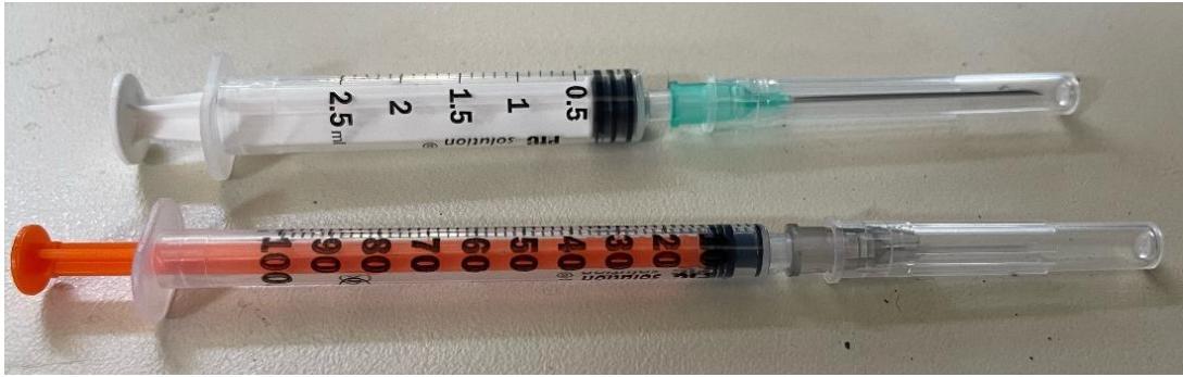
Σχήμα 3.17 Σύριγγες για την έγχυση ροδαμίνης στις δεξαμενές
