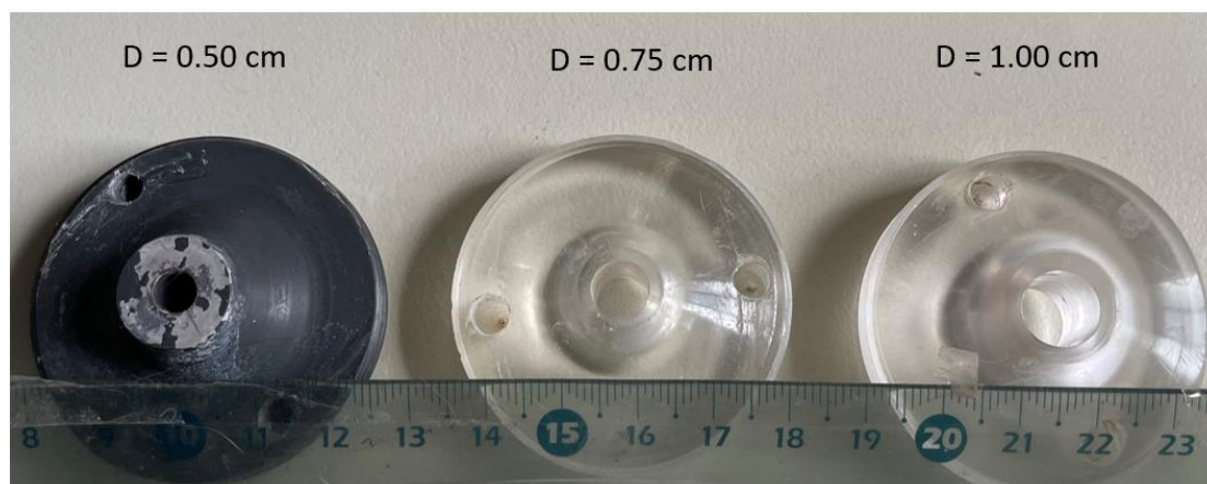
Σχήμα 3.2 Κυκλικά στόμια που χρησιμοποιήθηκαν για τα πειράματα διαμέτρων D = 0.50, 0.75 και 1.00 cm (από αριστερά προς τα δεξιά)
