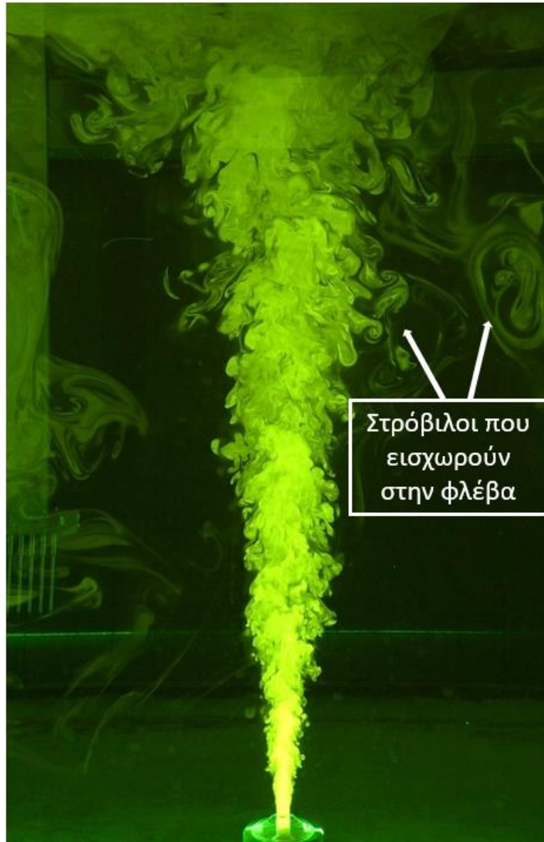
Σχήμα 3.18 Στιγμιότυπο από τη χρονική στιγμή που εισχωρούν οι στρόβιλοι πάλι στην φλέβα
