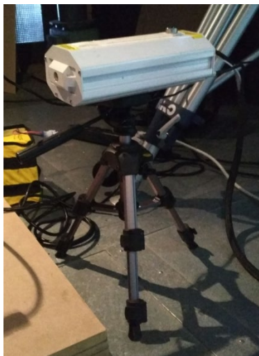
Σχήμα 4.3. α) Ταλαντόμετρο τεχνολογίας Laser Doppler, Vibromet 500V και β) Laser Tracker Vantage της εταιρείας FARO
