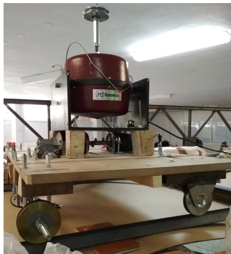
Σχήμα 6.12. Το ηλεκτροκίνητο όχημα με τη μονάδα διέγερσης επί αυτού
