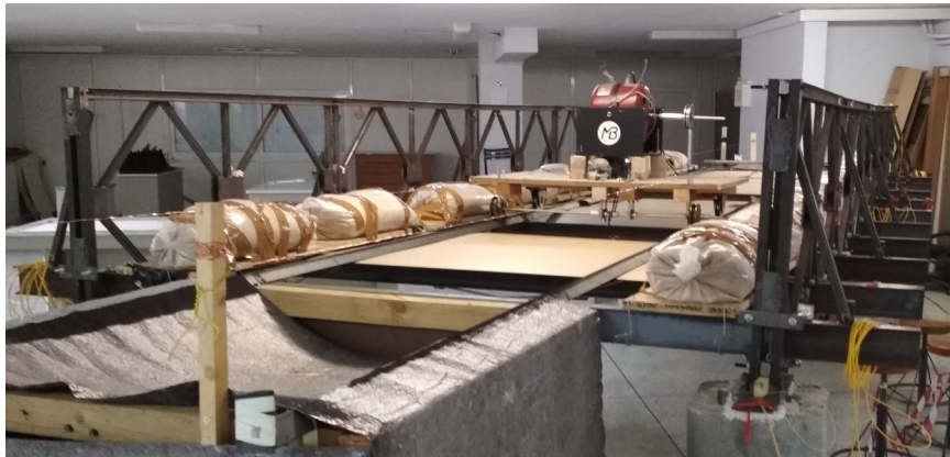
Σχήμα 6.13. Εξαναγκασμένη κίνηση οχήματος επί σιδερένιων ραγών στο κατάστρωμα της γέφυρας
