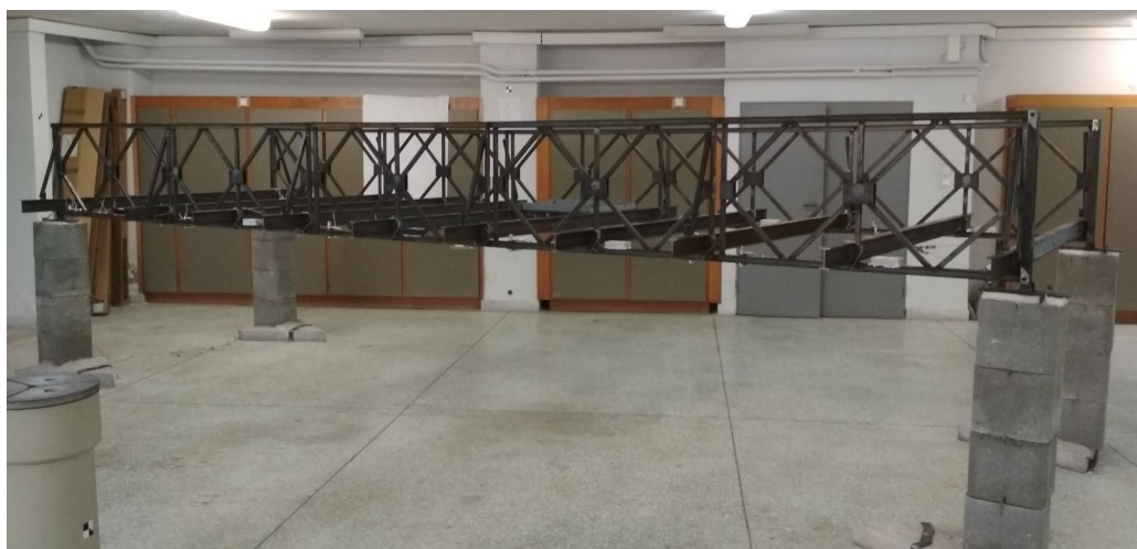
Σχήμα 6.6. Το φυσικό ομοίωμα γέφυρας τύπου Bailey εγκατεστημένο στον εργαστηριακό χώρο
