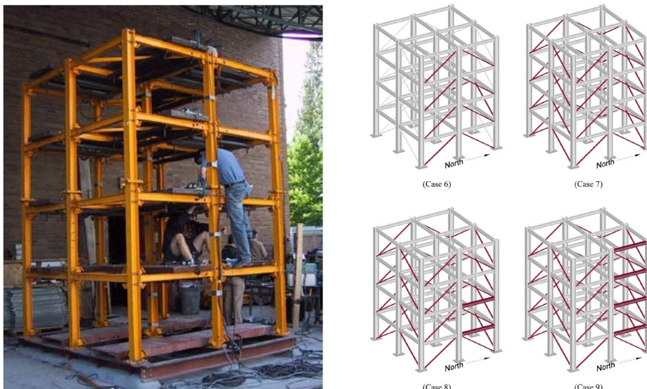
Σχήμα 5.14. Ομοίωμα κατασκευής (αριστερά) [Dyke et al. , 2003] και επιλεγμένα σενάρια δομικών βλαβών (δεξιά) [Abdeljaber et al. , 2018]
