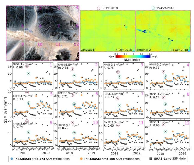
Figure 3.5 InSAR4SM SSM (volumetric %) estimations vs ERA5-Land soil moisture (volumetric %) estimations
