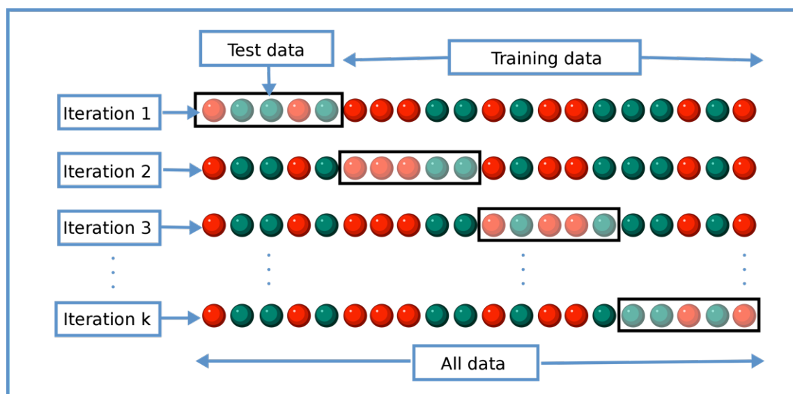
Εικόνα 22: k-fold cross-validation (πηγή: [31])
