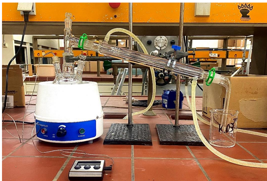
Σχήμα 24: Διάταξη παραγωγής γαλακτικού αιθυλεστέρα.
