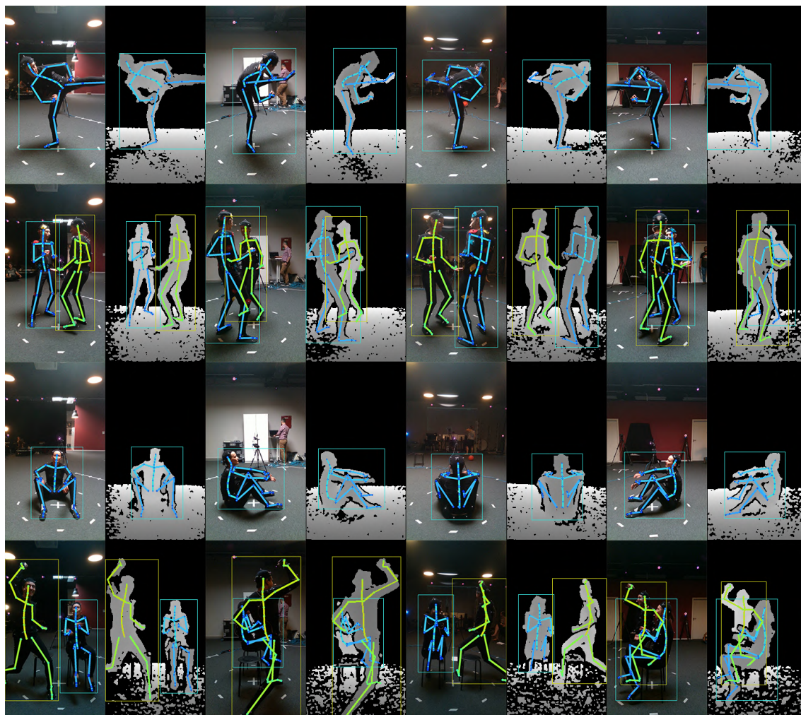
Σχήμα 4.6: Σημάνσεις πόζας και τετραγωνικού περιγράμματος σε κάποια δείγματα δεδομένων χρώματος και βάθους. Σε κάθε σειρά απεικονίζονται οι 4 διαφορετικές προβολές των καρέ από τυχαία δείγματα του συνόλου από διαφορετικές δραστηριότητες ενός και δύο ατόμων.
