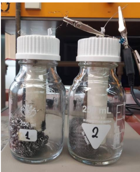
Εικόνα 15 - MFC1 wire (αριστερά) , MFC2 sponge (δεξιά) - άδεια.
