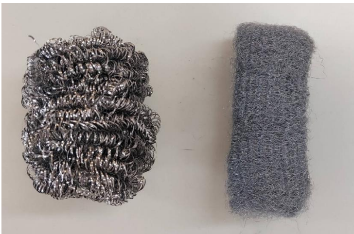
Εικόνα 14 – Άνοδοι από ανοξείδωτο χάλυβα, καλωδιακής μορφής (wire) αριστερά, σπογγώδους μορφής (sponge) δεξιά.
