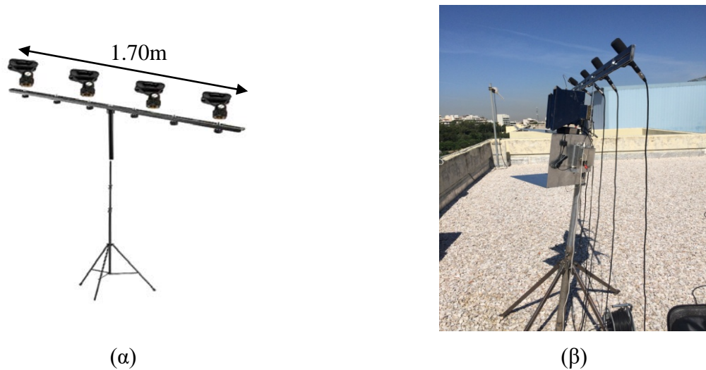
Εικόνα 4.9: (α) Σχηματικό διάγραμμα και (β) υλοποίηση ευθύγραμμης συστοιχίας μικροφώνων
