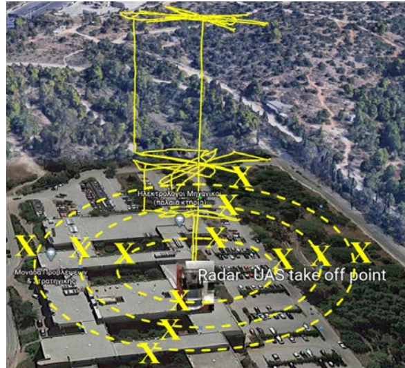
Σχήμα 4.8: Ίχνος πτήσης του UAS κατά τις δοκιμές λειτουργίας σάρωσης 360°
