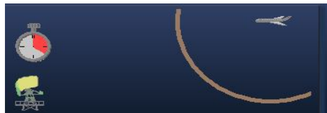
Εικόνα 2.2: Επιστροφή ανακλώμενου κύματος από στόχο
