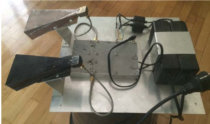
Εικόνα 4.7: Αρχική μορφή ραντάρ 24 GHz
