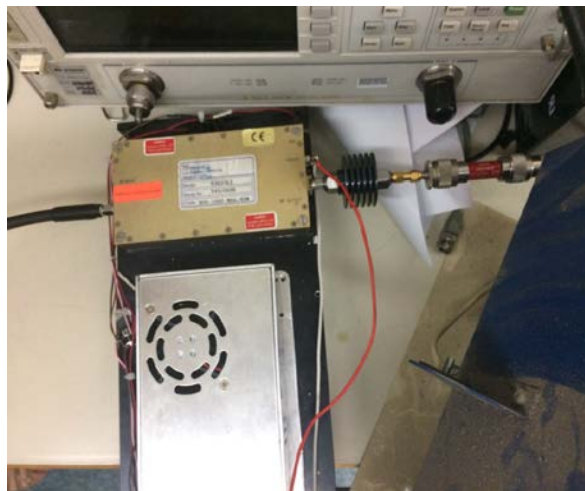
Εικόνα 4.2: Διάταξη ενισχυτή σήματος εκπομπής
