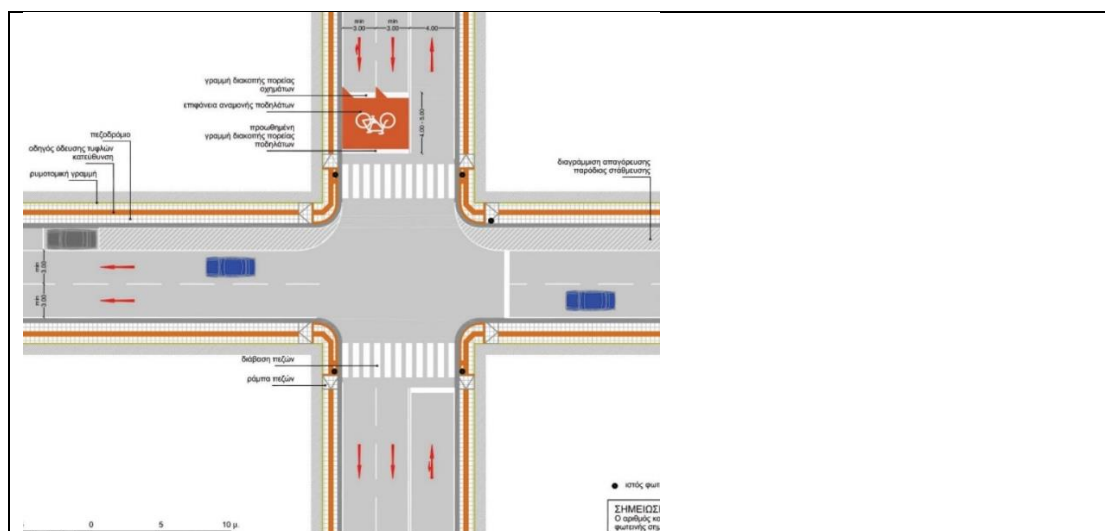
Οριζοντιογραφία με χώρο αναμονής, (Υπουργείο υποδομών, 2016), σελ. 13704
