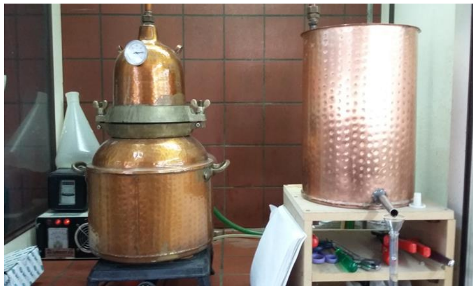
Εικόνα 5.6 Διάταξη υδροατμοαπόσταξης ανοιχτού κυκλώματος, κατασκευασμένη από χαλκό για την ανάκτηση των αιθέριων ελαίων των αρωματικών φυτών.
