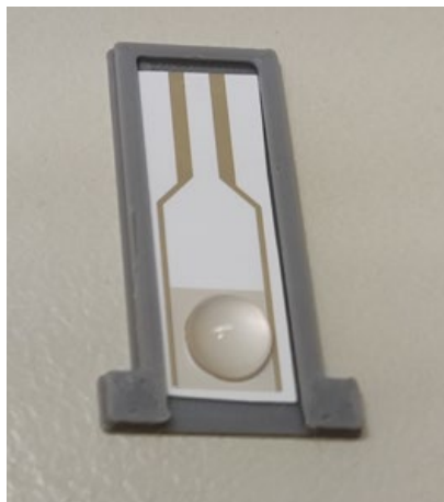
Σχήμα 33 Interdigital Πυκνωτής χρυσών ηλεκτροδίων με 30μl COWREV εκκινητή
