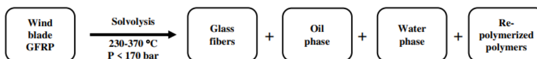
Σχήμα 8: Προϊόντα από πτερύγια ανεμογεννητριών μέσω της σολβόλυσης με υποκρίσιμο νερό (Mattsson et al., 2020).
