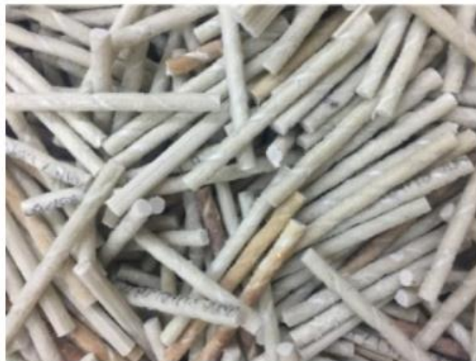
Εικόνα 29: Κυλινδρικά κομμάτια gfrp με διάμετρο 6 mm και μήκος 100 mm (Yazdanbakhsh et al., 2018).
