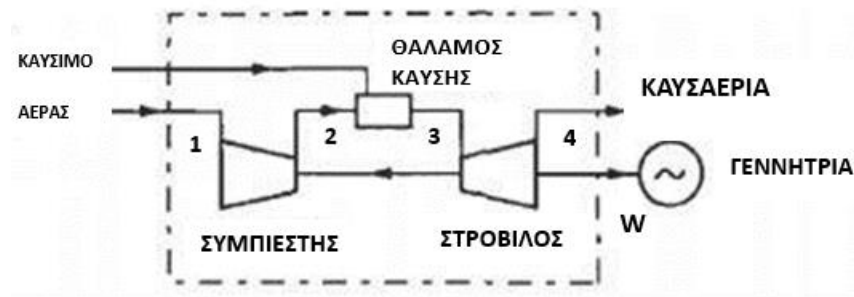
Εικόνα 3.2: Σχηματικό Διάγραμμα ενός ανοιχτού κύκλου αεριοστρόβιλου.
