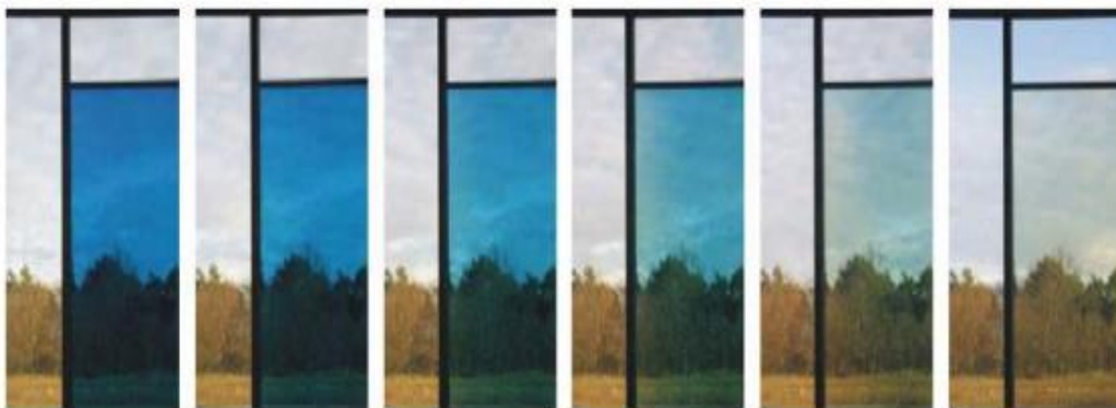
Σχήμα 2.7: Εναλλαγή οπτικών χαρακτηριστικών ηλεκτροχρωμικού υαλοπίνακα
