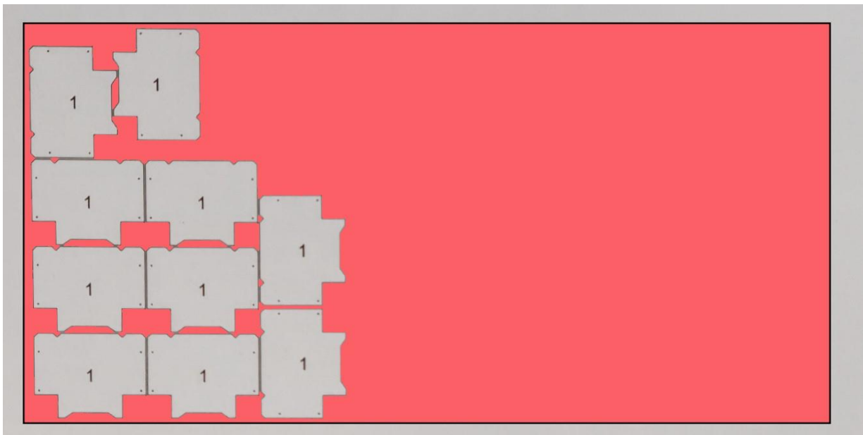
Εικόνα 5.7 Nesting Μεταλλικού Φύλλου
