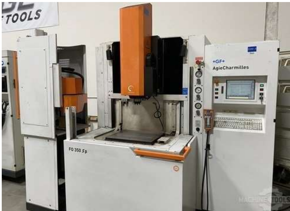
Εικόνα 13: EDM machine AgieCharmilles Roboform 350 Sp.
