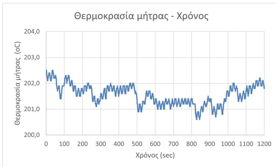
Σχήμα 52: Διακύμανση θερμοκρασίας στην έξοδο της μήτρας κατά τη διάρκεια της παραγωγής του compound σε δικόχλιο εκβολέα.
