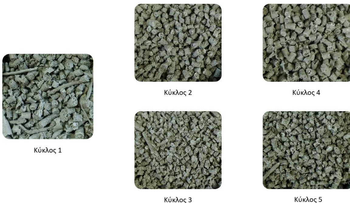
Εικόνα 34: Προϊόν κάθε κύκλου εκβολής compound με ξηρό SCR σε μονοκόχλιο εκβολέα.
