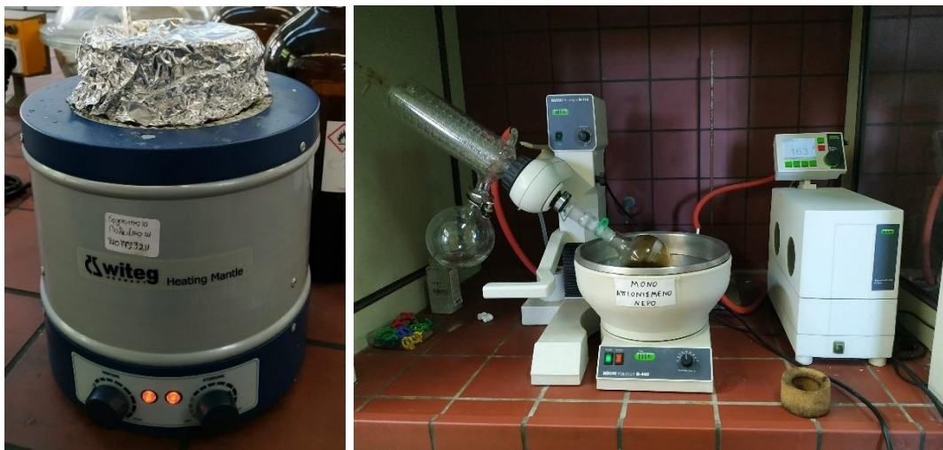
Εικόνα 19: Εκχύλιση υπό συμβατική θέρμανση και συνεχή ανάδευση (αριστερά) και εξάτμιση σε περιστροφικό εξατμιστήρα (δεξιά).
