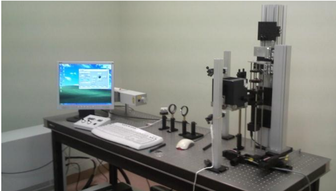
Εικόνα 21: Φωτογραφία της πειραματικής διάταξης εναπόθεσης υλικών υγρής φάσης με χρήση Λείζερ
