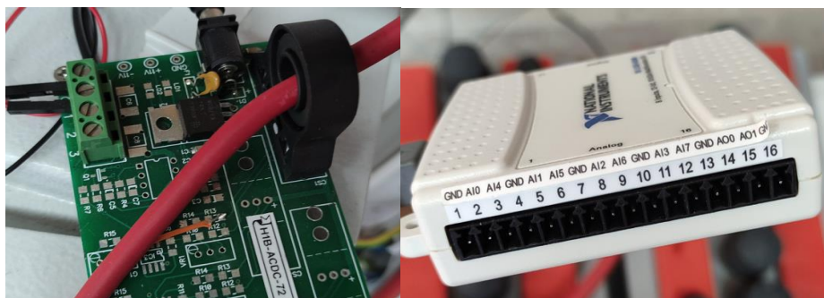
ΕΙΚΟΝΑ 48 ΑΡΙΣΤΕΡΑ: ΤΟ ΔΙΕΡΧΟΜΕΝΟ ΑΠΟ ΤΟΝ ΑΙΣΘΗΤΗΡΑ HALL ΚΑΛΩΔΙΟ. ΔΕΞΙΑ: ΟΙ ΘΥΡΕΣ ΑΝΑΛΟΓΙΚΟΥ ΣΗΜΑΤΟΣ ΤΗΣ ΠΛΑΚΕΤΑΣ DAQ-6008. ΓΙΑ ΝΑ ΠΑΡΟΥΜΕ ΤΗΝ ΜΕΤΡΗΣΗ ΤΗΣ ΤΑΣΗΣ ΑΠΟ ΤΟΝ ΑΙΣΘΗΤΗΡΑ HALL ΑΡΚΕΙ ΝΑ ΣΥΝΔΕΣΟΥΜΕ ΕΝΑ ΚΑΛΩΔΙΟ ΣΤΟ GND (GROUND) ΚΑΙ ΕΝΑ ΣΤΟ ΑΝΤΙΣΤΟΙΧΟ AI (ANALOG INPUT).
