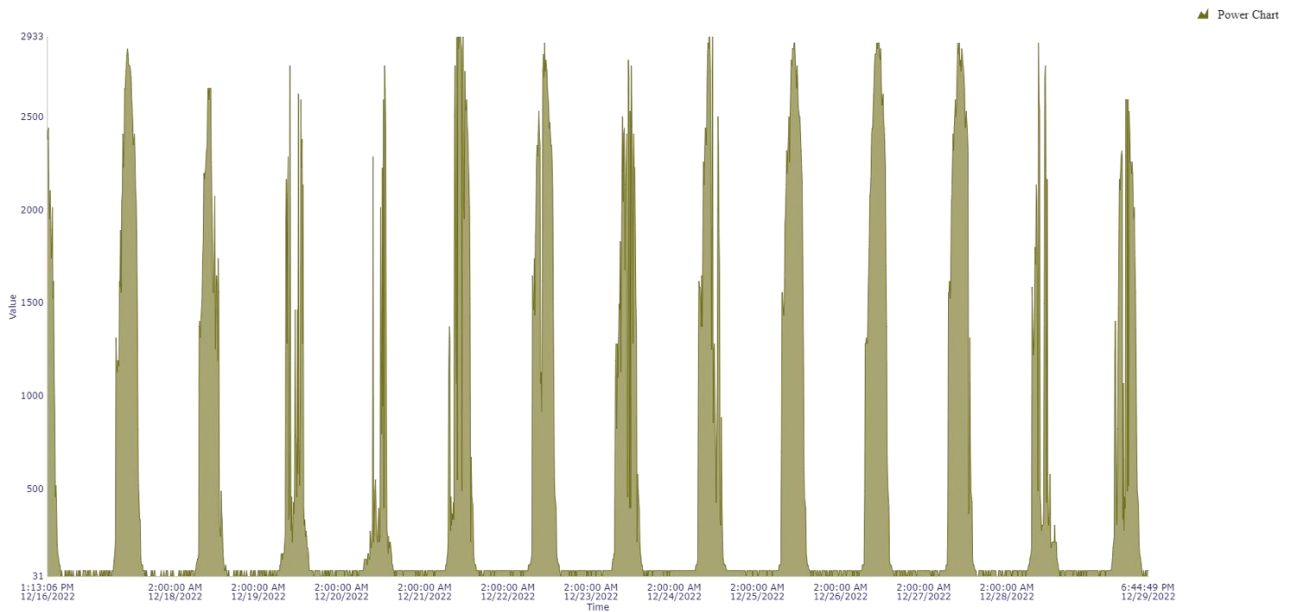
ΕΙΚΟΝΑ 94 ΠΑΡΑΧΘΕΙΣΑ ΕΝΕΡΓΕΙΑ ΦΩΤΟΒΟΛΤΑΪΚΟΥ ΓΙΑ ΤΟ ΔΙΑΣΤΗΜΑ ΑΠΟ 16.12.22 ΕΩΣ 29.12.22. (ΠΕΡΙΟΔΟΣ ΜΕΤΡΗΣΕΩΝ 10 ΛΕΠΤΑ) ΠΗΓΗ HTTPS://WWW.SYSTEMLINKCLOUD.COM/DATA/TAGS .
