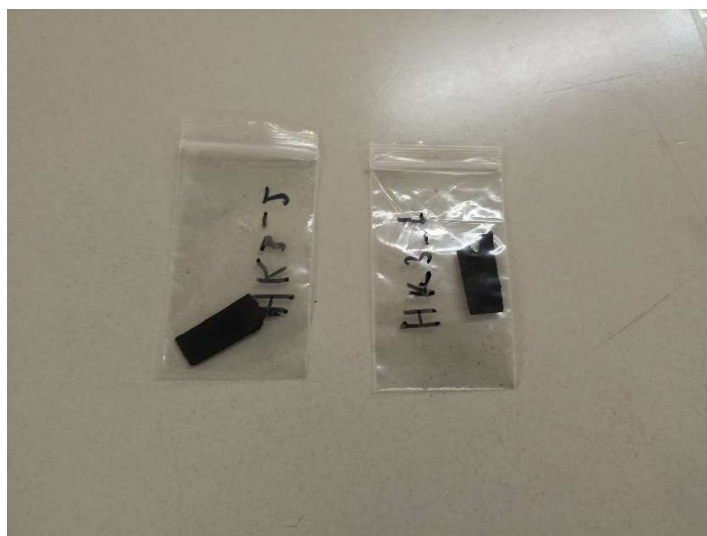
Εικόνα 19. Ηλεκτρόδια Carbon Paper με εναπόθεση του σύνθετου ZIF-8/CNT πάνω τους
