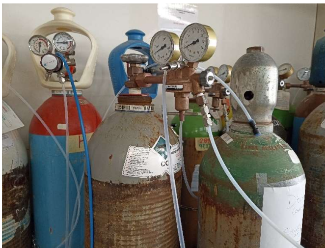
Εικόνα 21. Έλεγχος της Παροχής των Αερίων. Το CO 2 ρέει κατευθείαν μέσα στο ηλεκτρολυτικό κελί.
