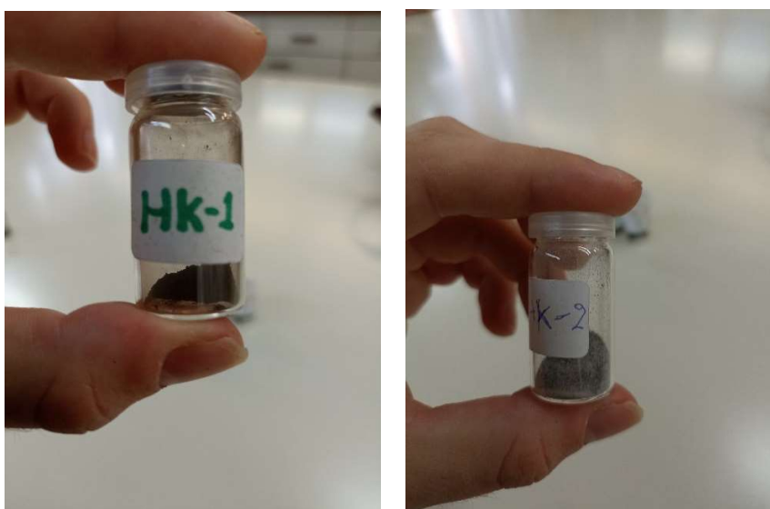
Εικόνα 17. Δείγματα HK#1 και HK#2 μετά την ξήρανση και την κονιοποίηση τους
