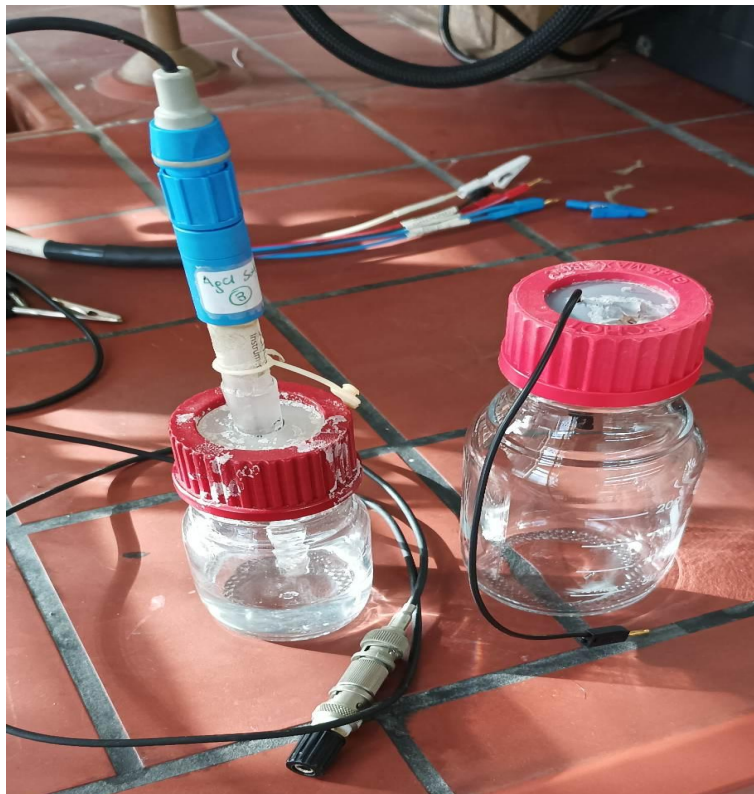
Εικόνα 3.6. : Διάταξη συστήματος τριών ηλεκτροδίων
