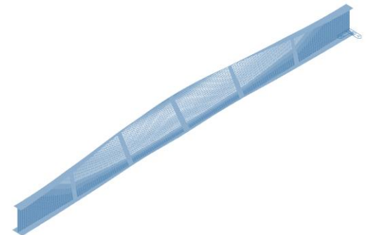
Σχήμα 20.4 : 1η Ιδιομορφή απο LBA με Εγκάρσιες Νευρώσεις
