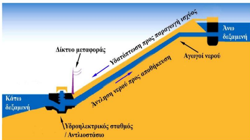
Σχήμα 2.1 Βασική δομή και λειτουργία ενός αναστρέψιμου υδροηλεκτρικού.
