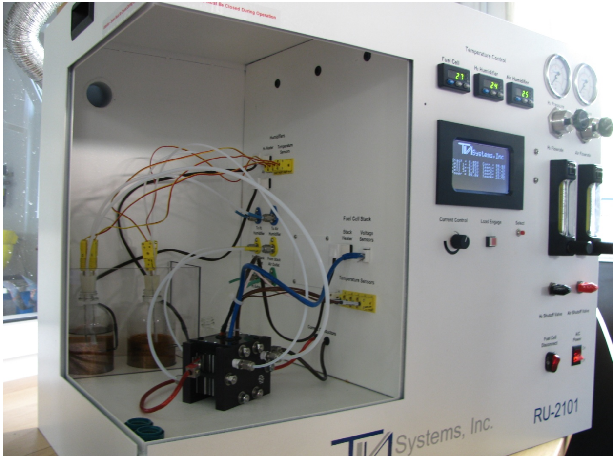
Εικ. 3.1. Δοκιμαστήριο κυψελών καυσίμου RU-2101.
