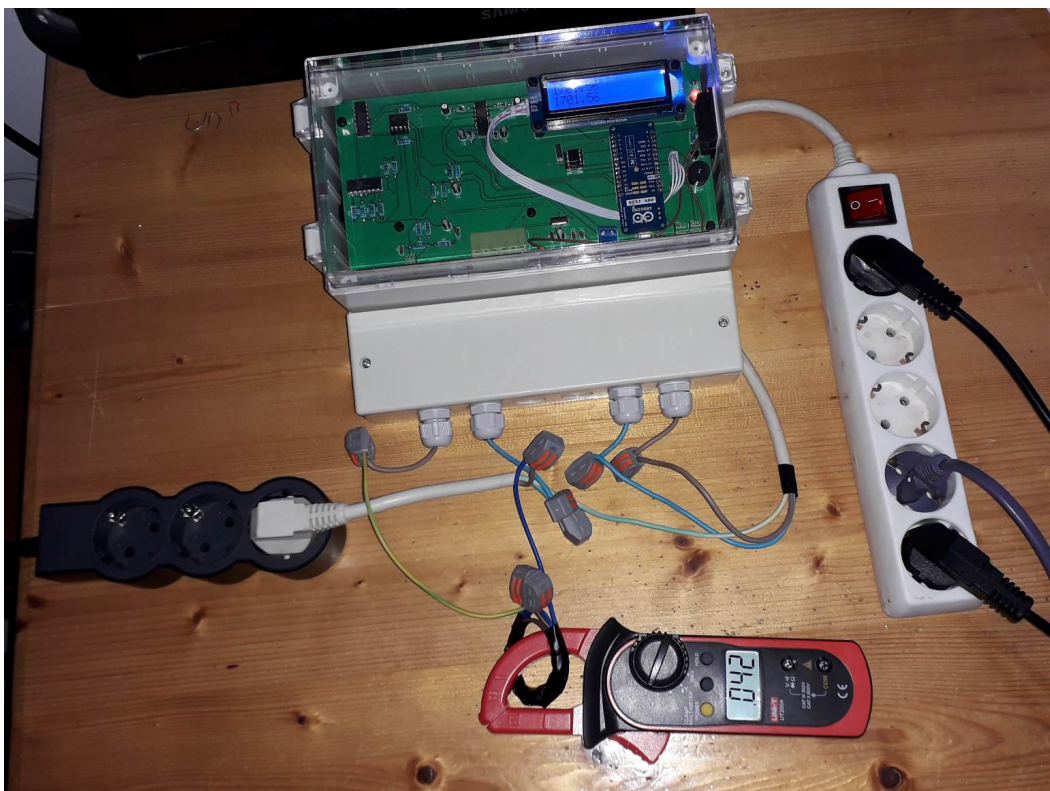
Σχήμα 5.14: Διάταξη calibration για μικρές τιμές ρεύματος.
