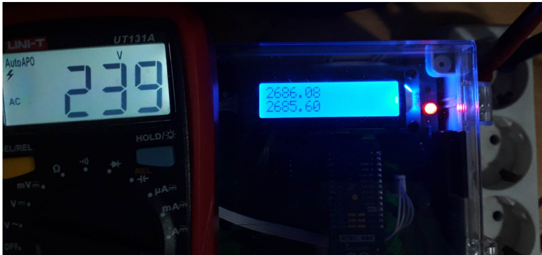
Σχήμα 5.16: Φωτογραφίες από την διαδικασία του calibration της τάσης.
