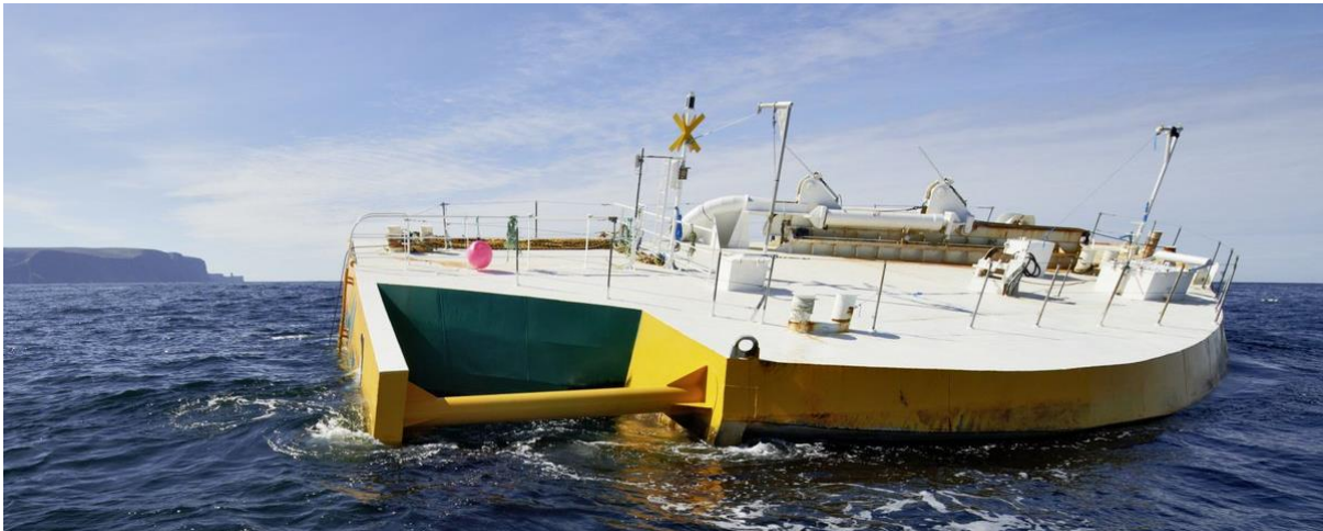
Εικόνα 28 Κυματική Μηχανή Penguin (Πηγή: Wello)
