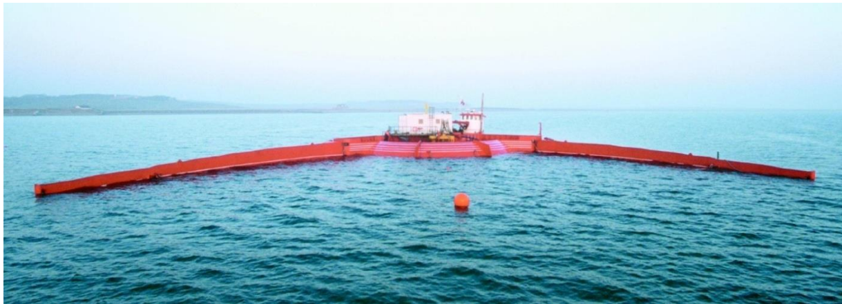
Εικόνα 22 Κυματική Μηχανή WaveDragon (Πηγή: WaveDragon Technology)
