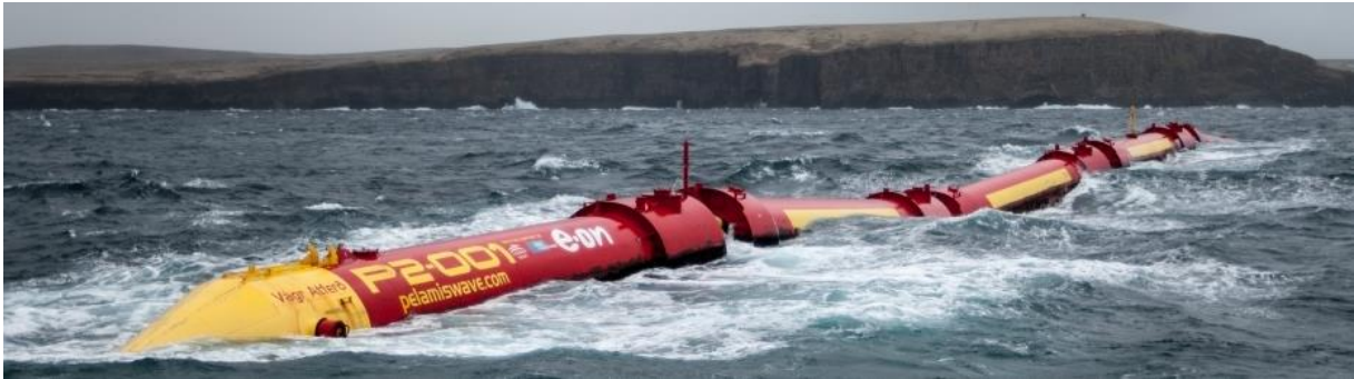
Εικόνα 14 Κυματική Μηχανή Pelamis (Πηγή: EMEC: European Marine Energy Centre)
