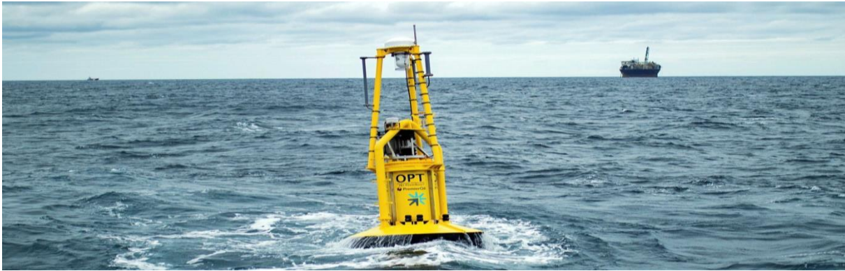
Εικόνα 16 Κυματική Μηχανή PowerBuoy (Πηγή: Ocean Power Technologies)
