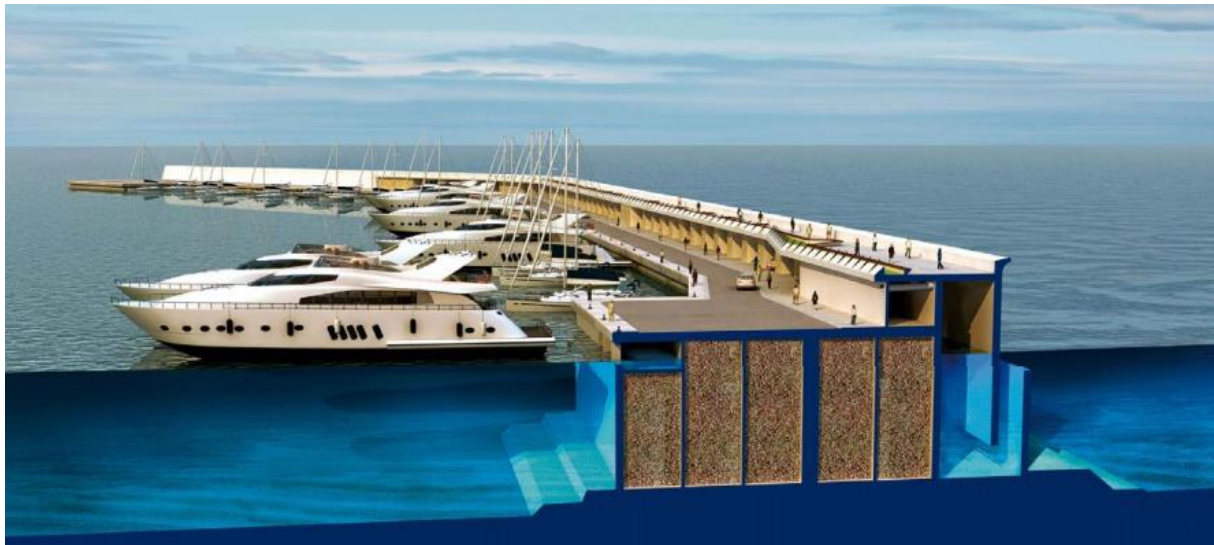
Εικόνα 20 Κυματική Μηχανή REWEC3 (Πηγή: Wavenergy.it)
